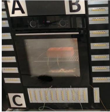
Şekil 2.2. Tuğla ile sıcaklık ölçümü deneyleri yapılan test kabini ve deney yapılan fırın görseli.
