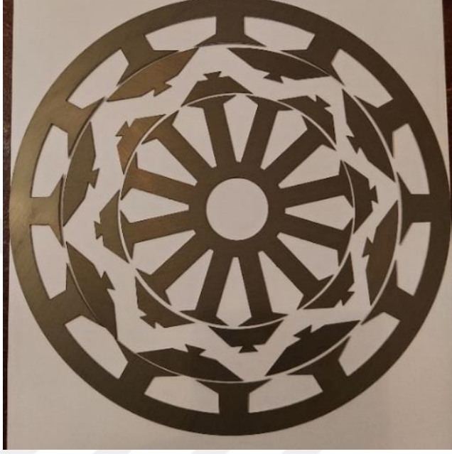
Şekil 6.2 ÇSARM stator ve rotor parçaları
