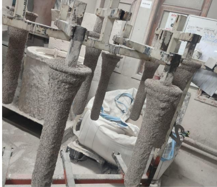
Şekil 4. 7. Beşinci kat kaplaması yapılmış numune görüntüsü
