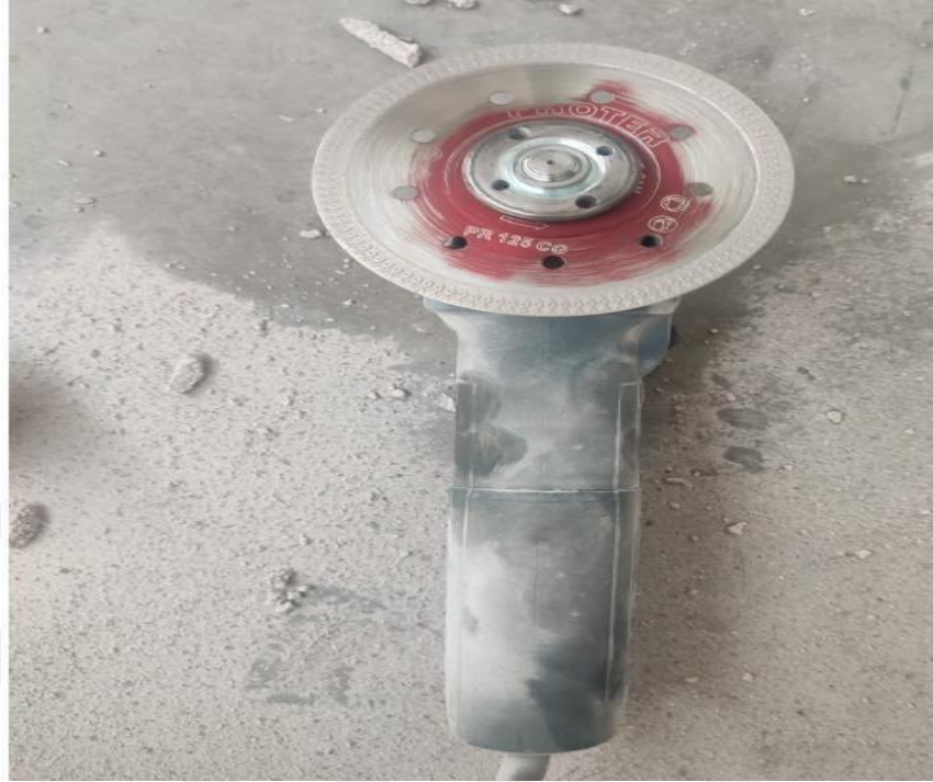
Şekil 4. 12. Kesme işlemi için kullanılan spiral taş
