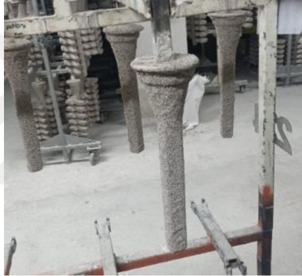
Şekil 4. 4. İkinci kat kaplaması yapılmış numune görüntüsü
