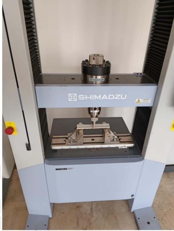
Şekil 4. 18. Üç nokta eğme deneyi yapılan cihaz
