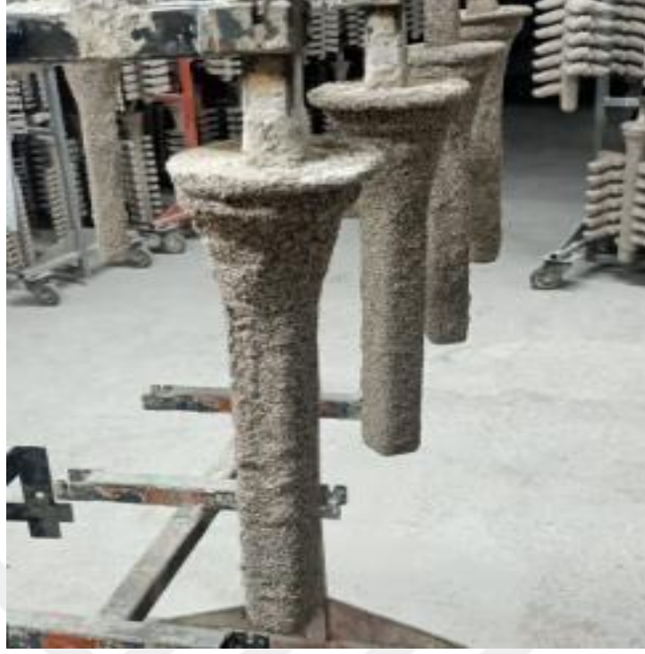
Şekil 4. 6. Dördüncü kat kaplaması yapılmış numune görüntüsü
