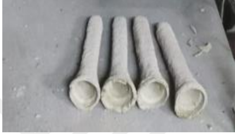
Şekil 4. 10. Otoklav yapılarak mumu giderilmiş numuneler
