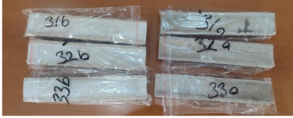
Şekil 4. 17. Yedi kat sayılı, 60 dk artırımlı kurutma süresi olan deney grubuna ait numuneler
