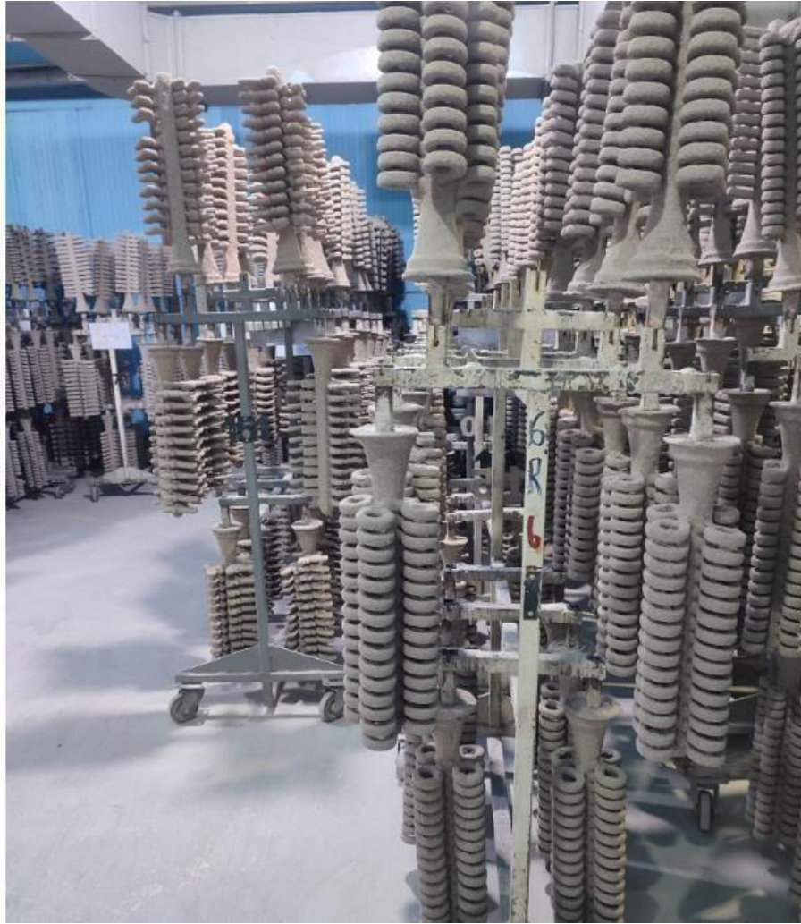
Şekil 3. 11. Seramik salkım kuruma ortamı düzeni
