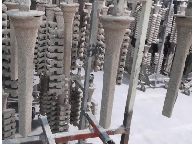
Şekil 4. 3. İlk kat kaplaması yapılmış numune görüntüsü
