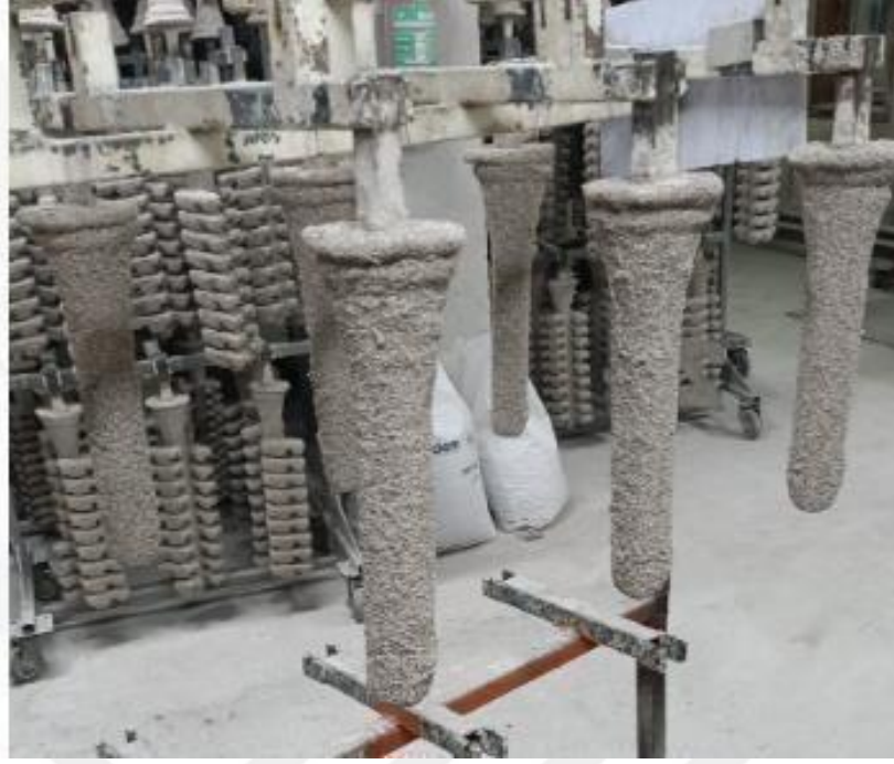
Şekil 4. 8. Altıncı kat kaplaması yapılmış numune görüntüsü
