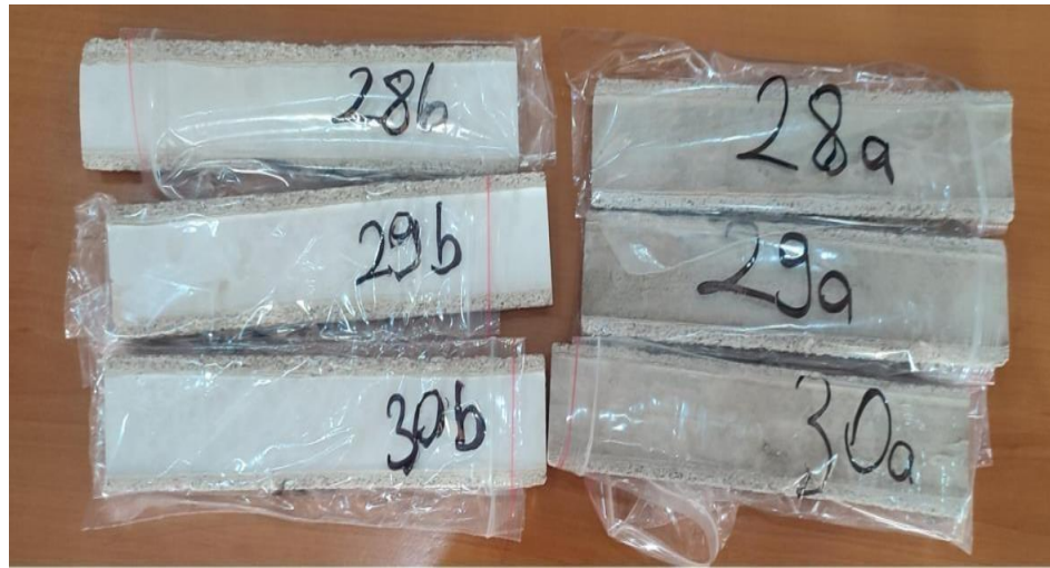
Şekil 4. 16. Beş kat sayılı, 30 dk artırımlı kurutma süreli ve dezenfektan ilaveli deney grubuna ait olan numuneler
