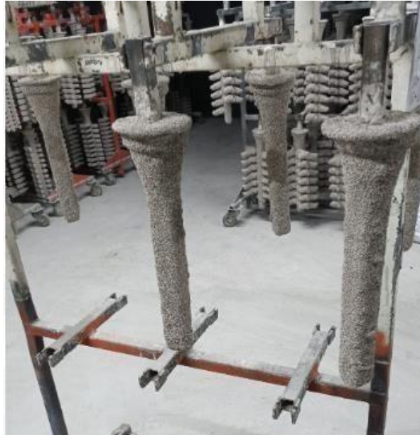
Şekil 4. 5. Üçüncü kat kaplaması yapılmış numune görüntüsü
