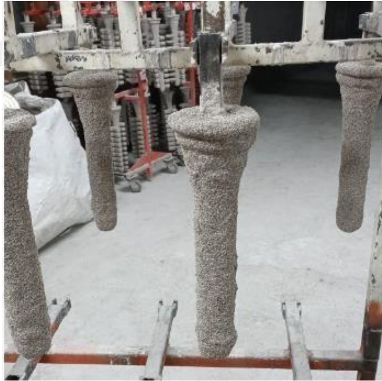
Şekil 4. 9. Yedinci kat kaplaması yapılmış numune görüntüsü
