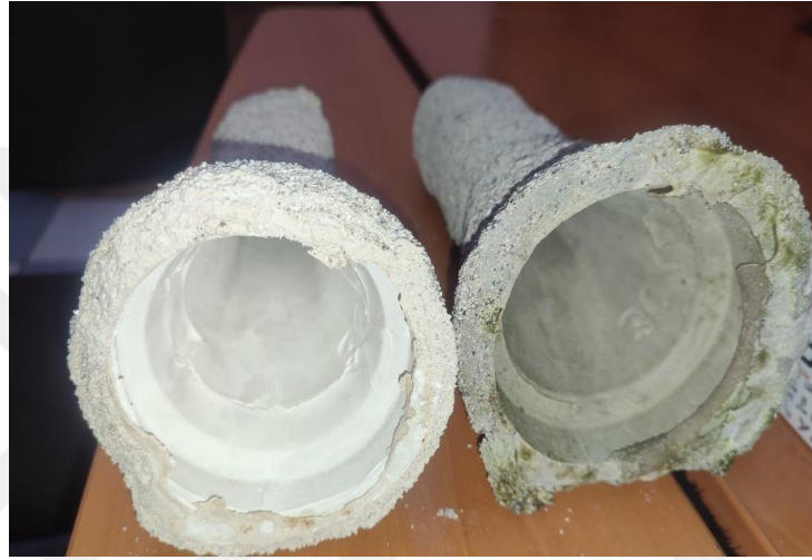
Şekil 3. 14. Mum giderme sonrası ısıtıl işlem yapılan ve yapılmayan ürünün iç yüzeyindeki mum farkı
