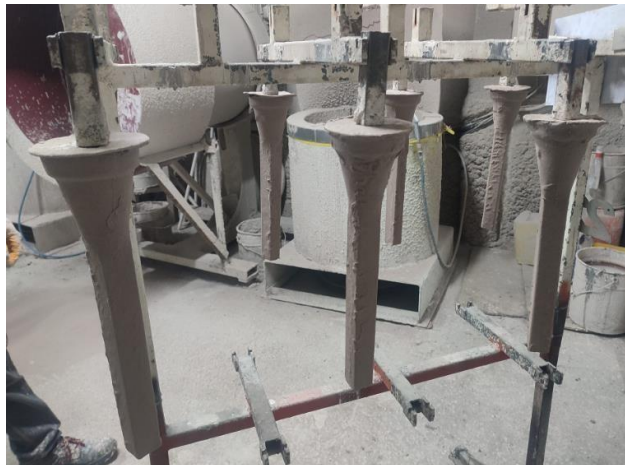
Şekil 4. 2. Ön kaplaması yapılmış numune görüntüsü
