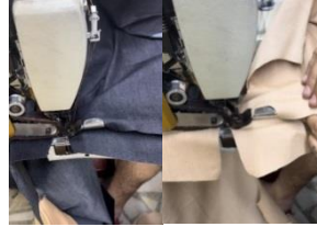
Şekil 3.139. Arka bedeni conta parçasının üstüne çatma
