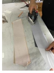
Şekil 3.99. Yakalara tela yapıştırma işlemi
