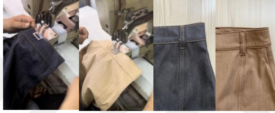
Şekil 3.75. Ön 1 ve 2 parçalarının köprü yerleşimi
