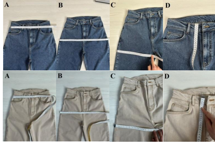
Şekil 4.30. Model 5 ve 6 yıkama sonrası ölçüm noktaları: A) Bel, B) Kalça, C) Baldır, D) Kemer genişliği
