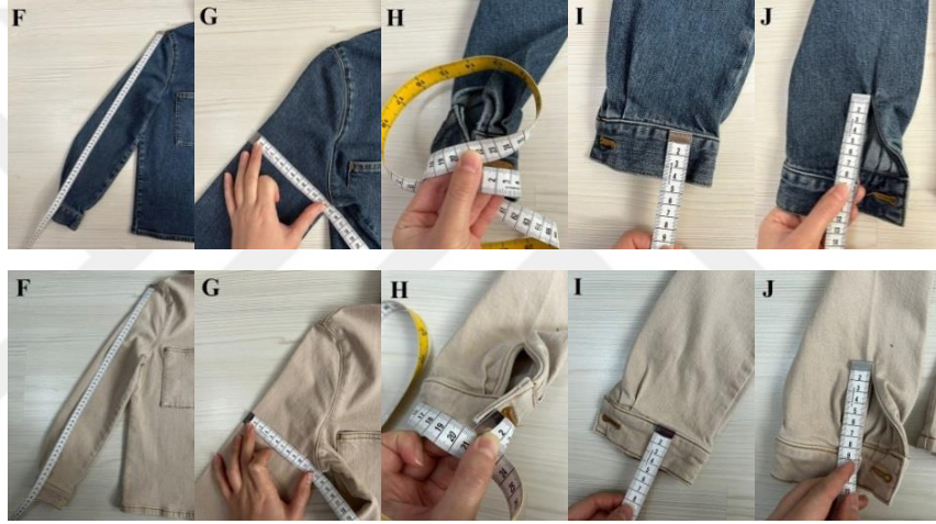
Şekil 4.44. Model 7 ve 8 yıkama sonrası ölçüm noktaları: F) Kol boyu, G) Pazu, H) Manşet kol ağzı, I) Manşet genişliği, J) Yırtmaç boyu
