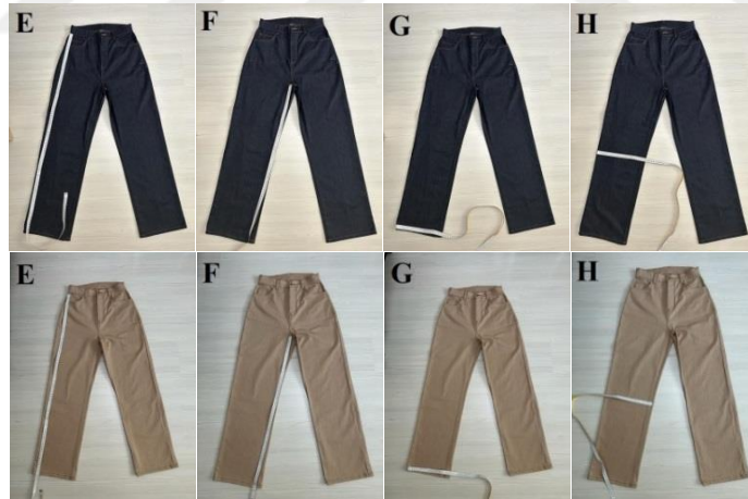
Şekil 4.29. Model 5 ve 6 yıkama öncesi ölçüm noktaları: E) Yan boy, F) İç boy, G) Paça genişliği, H) Diz genişliği
