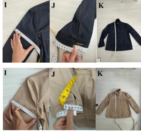
Şekil 4.13. Model 3 ve 4 yıkama öncesi ölçüm noktaları: I) Pazu, J) Manşet kol ağzı, K) Omuzdan model boyu
