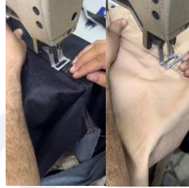
Şekil 3.149. Pat bitim noktası üstü punteriz
