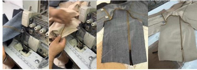
Şekil 3.108. Kol takımı 5 iplikli overlok
