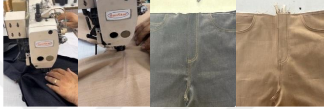
Şekil 3.138. Açıkta kalan ağ birleşimi
