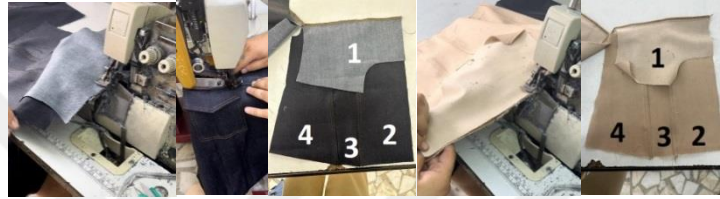
Şekil 3.93. Ön 1 parçasının, ön 2, 3, 4 ile birleşimi
