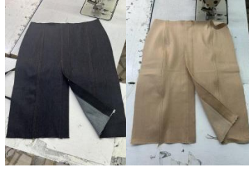
Şekil 3.66. Ön parçaların kollu ve çıma dikiş işlemleri sonrası görünümü
