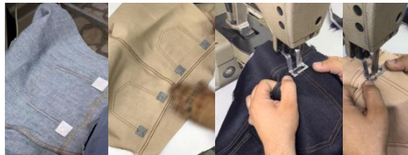
Şekil 3.147. Cep ağız keçe yapışımı ve punteriz dikimi
