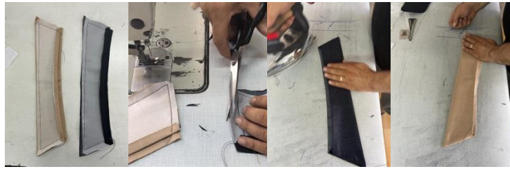
Şekil 3.101. Yaka dikimi ve ütü işlemi
