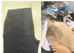
Şekil 3.136. Ön sağ Ağ 3 iplikli overlok çekimi
