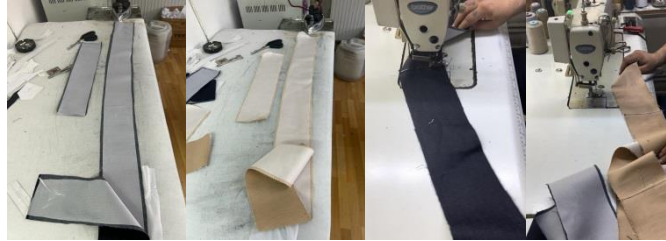
Şekil 3.111. Manşet ve kemer tela ve dikim işlemi
