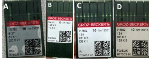
Şekil 3.7. A) Overlok iğnesi, B) Kollu ve kemer, C) Düz, punteriz, çift iğne makinesi, D) İnce iş
