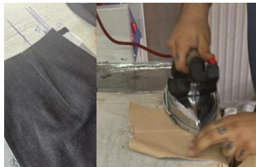
Şekil 3.62. Pens ütüleme işlemi
