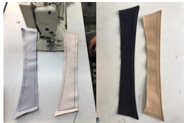
Şekil 3.177. Üst yaka dikimi ve yaka üstüne gaze dikişi
