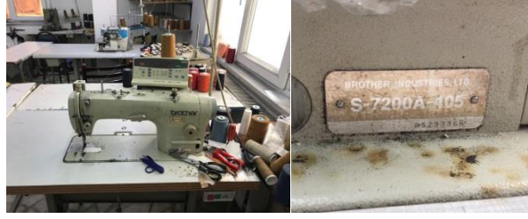
Şekil 3.12. Bilgisayarlı düz dikiş makinesi
