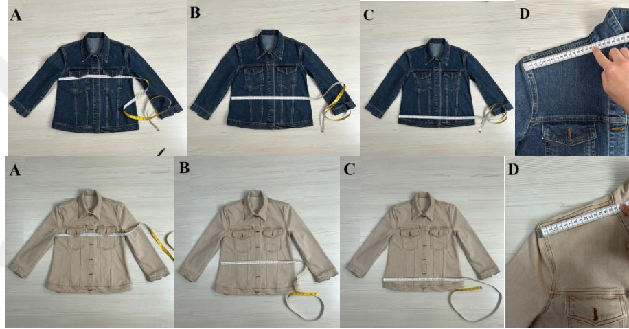
Şekil 4.14. Model 3 ve 4 yıkama sonrası ölçüm noktaları: A) Göğüs, B) Bel, C) Kalça, D) Omuz
