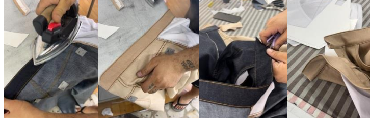
Şekil 3.156. Kemer ütüleme ve söküm
