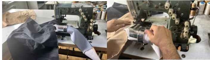
Şekil 3.69. Kemer makinesi aparatına, kemer genişliği 11 cm’ lik kumaşın verilmesi
