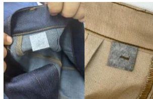
Şekil 3.77. Yan köprüler altına keçe yerleşimi
