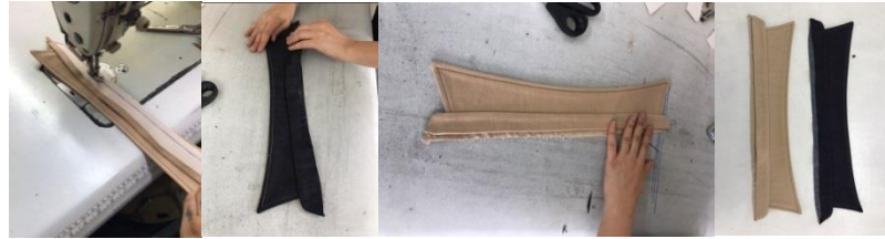
Şekil 3.180. Ayağı dikişli gömlek yaka dikim işlemi
