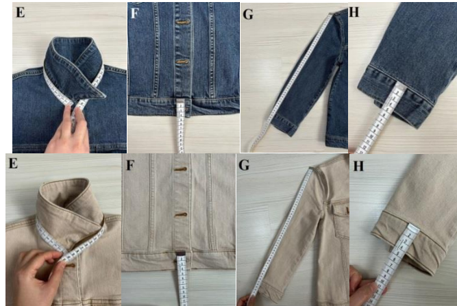
Şekil 4.15. Model 3 ve 4 yıkama sonrası ölçüm noktaları: E) Yaka çevresi, F) Kemer genişliği, G) Kol boyu(manşet hariç), H) Manşet genişliği
