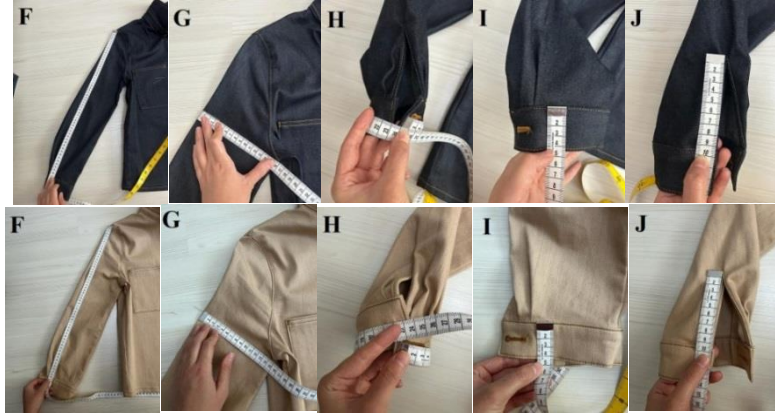
Şekil 4.41. Model 7 ve 8 yıkama öncesi ölçüm noktaları: F) Kol boyu, G) Pazu, H) Manşet kol ağzı, I) Manşet genişliği, J) Yırtmaç boyu
