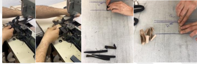
Şekil 3.157. Köprü yapımı ve ütü
