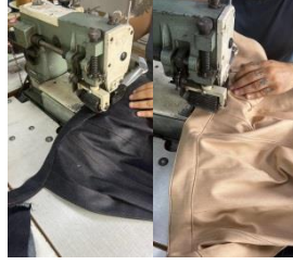
Şekil 3.70. Aparaya verilen kemerlerin çıkışı 4,5 cm
