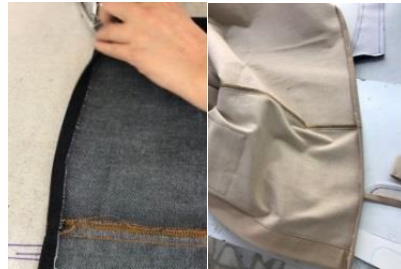
Şekil 3.184. Etek ucu katlama
