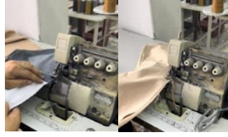
Şekil 3.152. Pantolon yan dikiş çatım noktası
