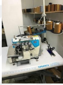
Şekil 3.10. Jack® 3 iplikli overlok
