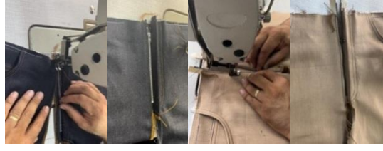
Şekil 3.137. Sağ ön beden Sol beden ile birleşimi
