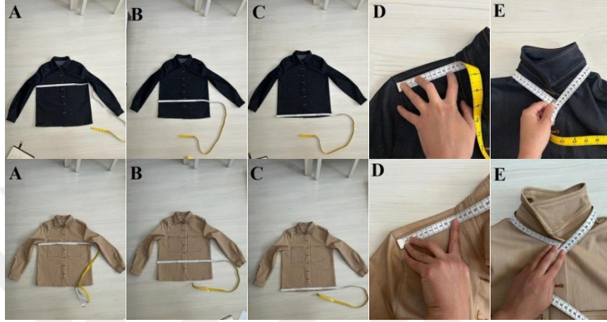
Şekil 4.40. Model 7 ve 8 yıkama öncesi ölçüm noktaları: A) Göğüs, B) Bel, C) Kalça, D) Omuz, E) Yaka çevresi
