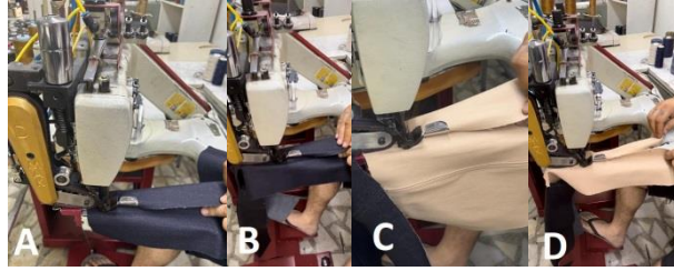
Şekil 3.82. A- C görselinde ön 2 parçası ön 3'te üstüne dikimi. B-D görselinde ön 4 parçası ön 3'te üstüne dikimi
