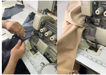
Şekil 3.170. Kolların bedene çatımı
