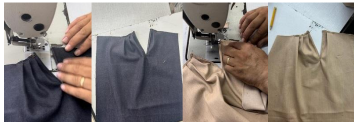
Şekil 3.166. Kol pile yapımı
