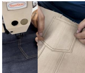
Şekil 3.88. Cep torbasının bedene dikimi
