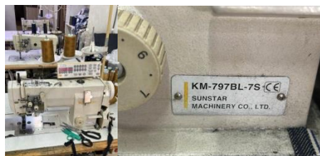
Şekil 3.15. İptalli çift iğne makine
