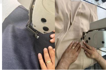
Şekil 3.68. Yan hatlarına 1 mm’ den çıma süs dikişi
