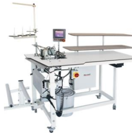
Şekil 2.39. Tek kafalı sürfile otomatı
