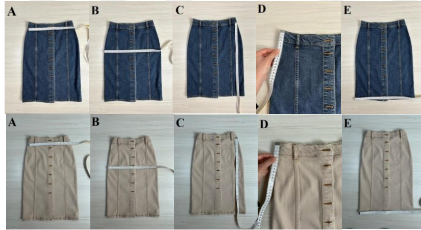
Şekil 4.5. Model 1 ve 2 yıkama sonrası ölçüm hatları: A) Bel, B) Kalça, C) Yandan etek boyu, D) Kemer genişliği, E) Etek ucu genişliği
