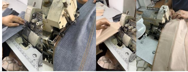
Şekil 3.67. Etek yan hatlarının 5 iplikli overlok makinesinde çatımı
