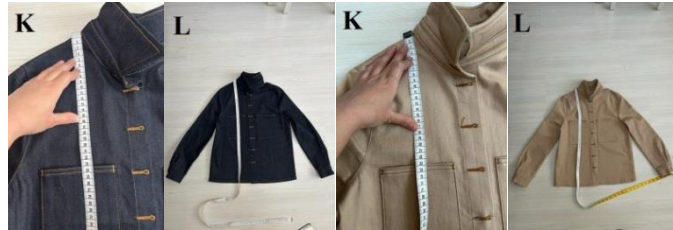
Şekil 4.42. Model 7 ve 8 yıkama öncesi ölçüm noktaları: K) Cep takım yüksekliği, L) Omuz başından boy
