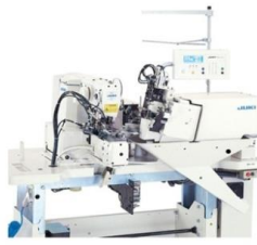
Şekil 2.41. Köprü takma otomatı
