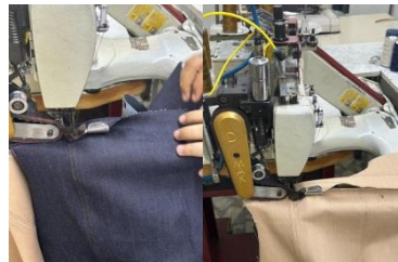
Şekil 3.84. Arka 1 roba parçasının birleşimi
