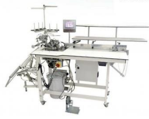
Şekil 2.40. Pantolon yan çatım otomatı
