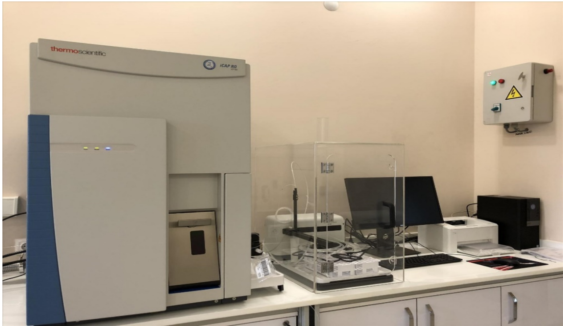
Şekil 15. ICP-MS cihazından (Thermo iCAP RQ) görünüm.
