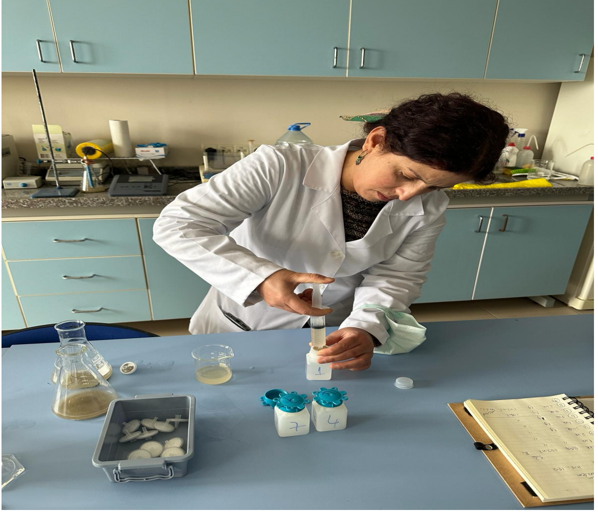
Şekil 13. Örneklerin ICP-MS analizi öncesi filtrelenmesi.
