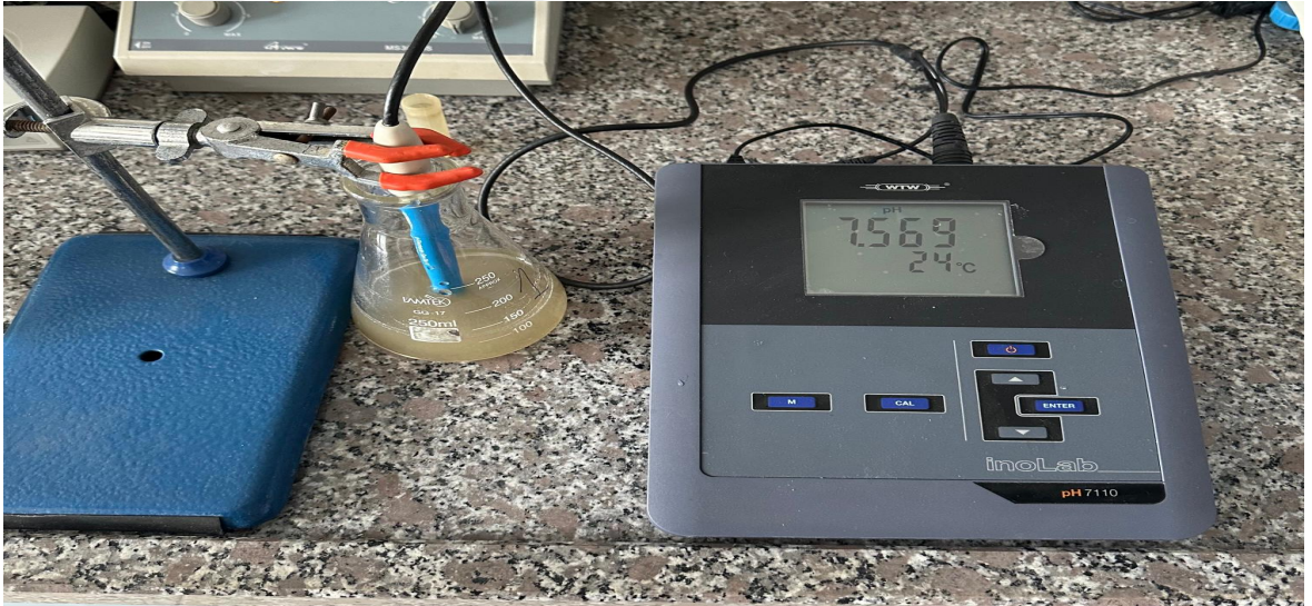
Şekil 12. Çözeltinin pH ölçümü.
