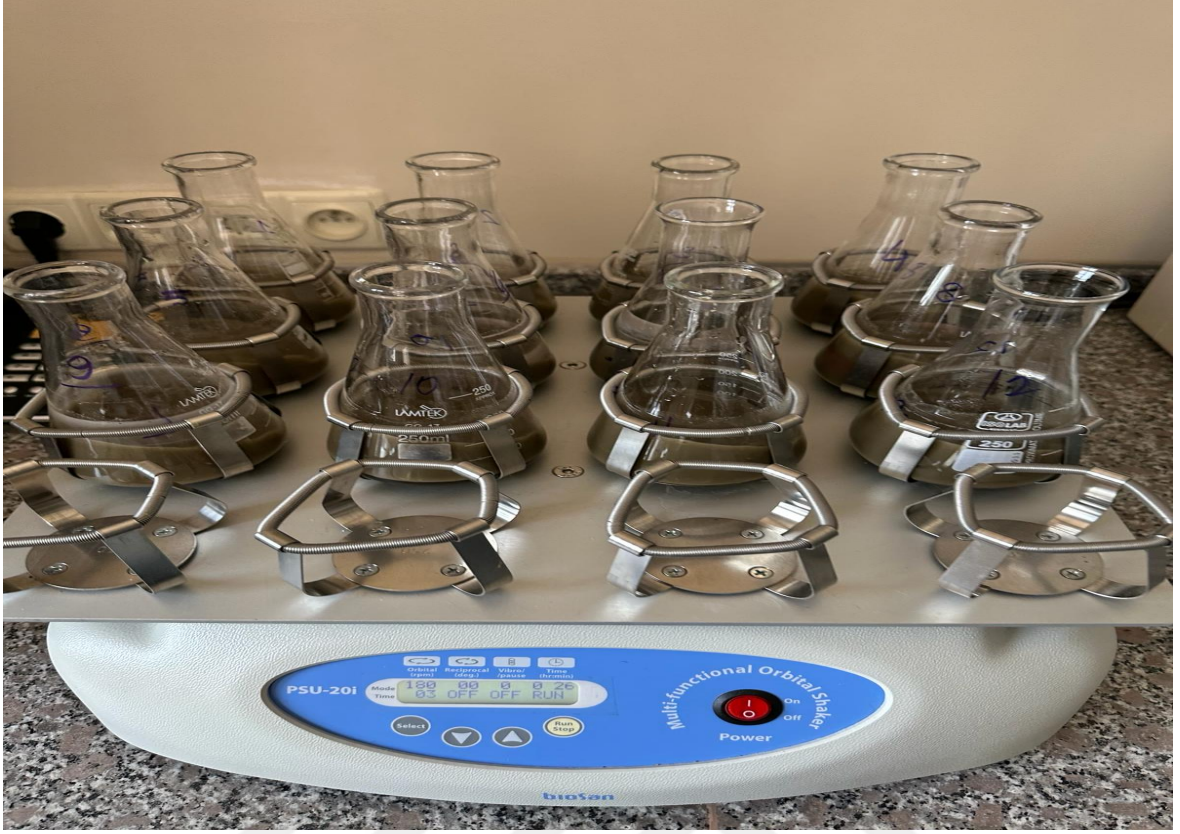
Şekil 11. Çözeltinin orbital çalkalayıcıda çalkalanması.
