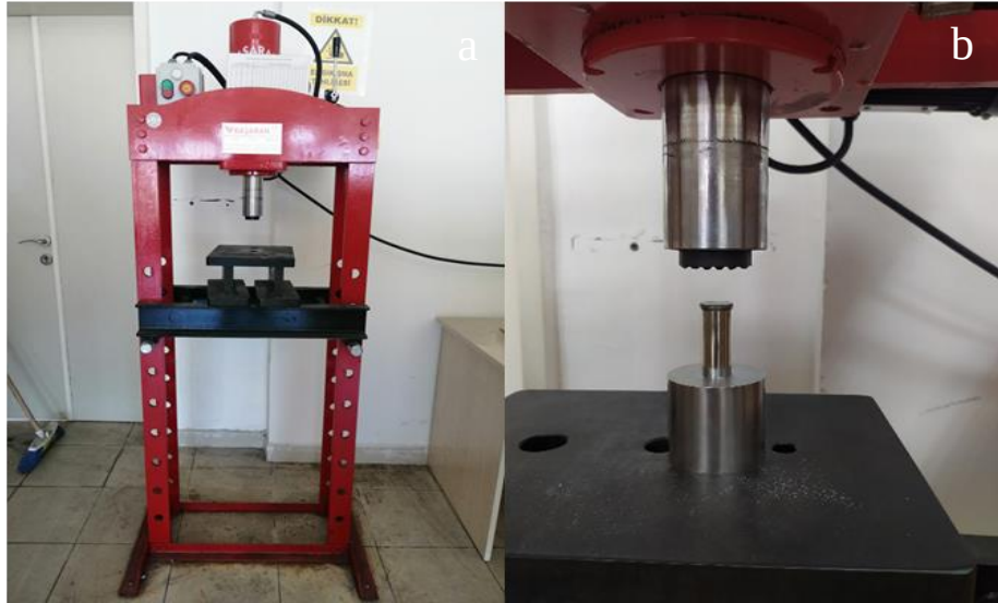
Şekil 4.21. Elektro hidrolik pres: (a) genel görünüm, (b) numunenin preslenme aşamasındaki görünümü
