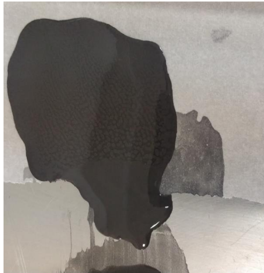
Şekil 4.7. Döküm sonrası yüzeyde görülen ayrışma
