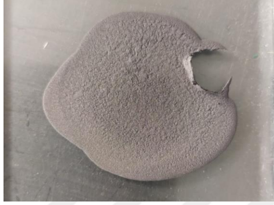
Şekil 4.11. WD40 kaplı cam altlık üzerine uygulanmış şerit döküm malzeme
