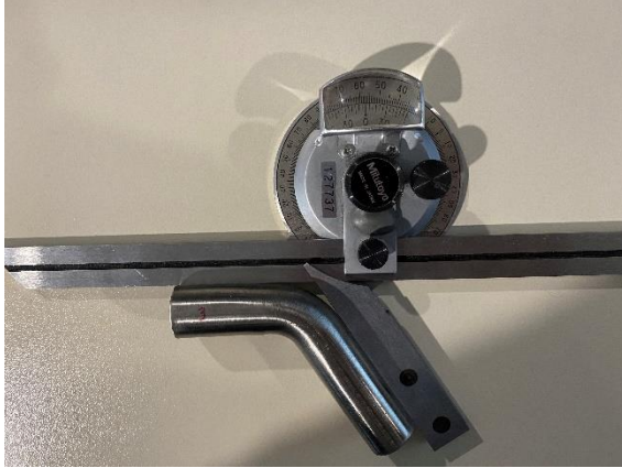
Resim 4.24. Deney 8.3 geri yaylanma değeri
