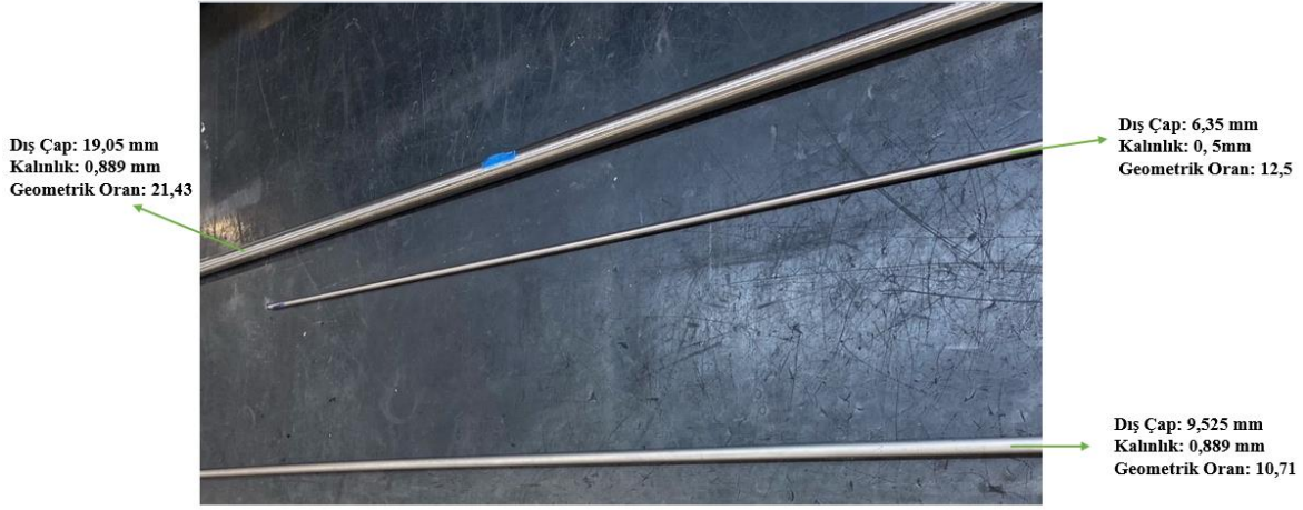
Resim 3.5. Deneysel çalışmada kullanılacak olan yarı mamul boru parçaları
