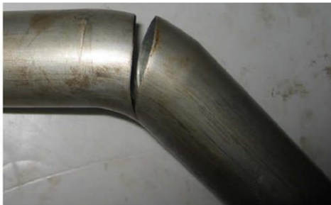
Resim 2.18. Boru parçası dış yüzeyinde meydana gelen yırtılma [13]
