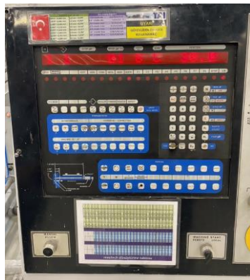
Resim 3.9. Büküm açısının kontrol ünitesine girilmesi
