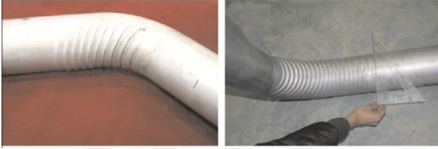
Resim 2.17. Boru parçası iç yüzeyinde meydana gelen kırışma [12]
