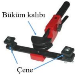
Resim 2.5. Gerdirme ile boru bükme
