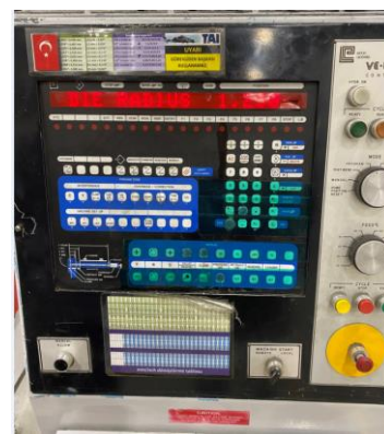
Resim 3.10. Büküm yarıçapının kontrol ünitesine girilmesi
