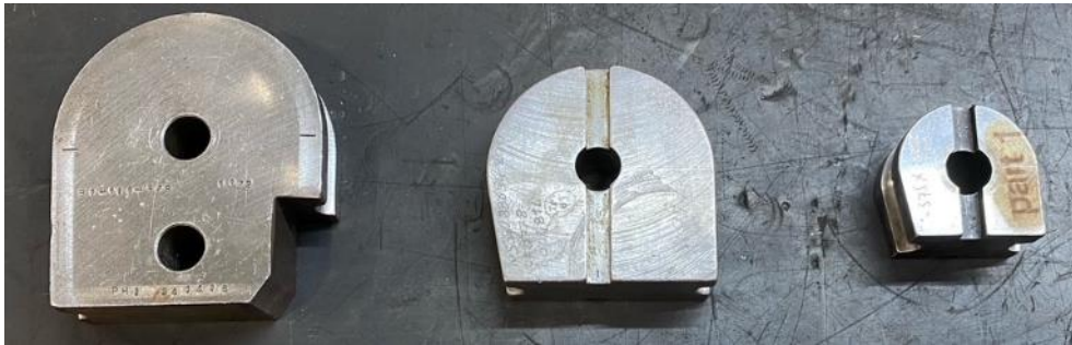
Resim 3.7. Büküm yarıçapına göre değişiklik gösteren büküm kalıpları
