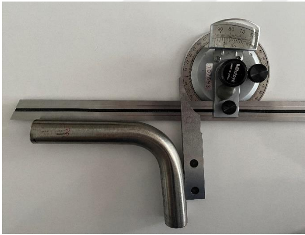
Resim 4.27. Deney 9.3 geri yaylanma değeri
