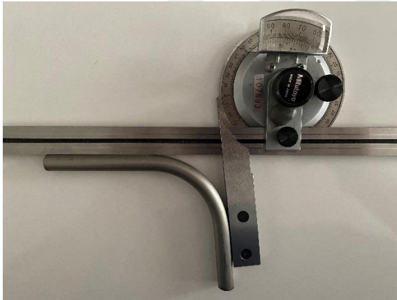
Resim 4.9. Deney 3.3 geri yaylanma değeri
