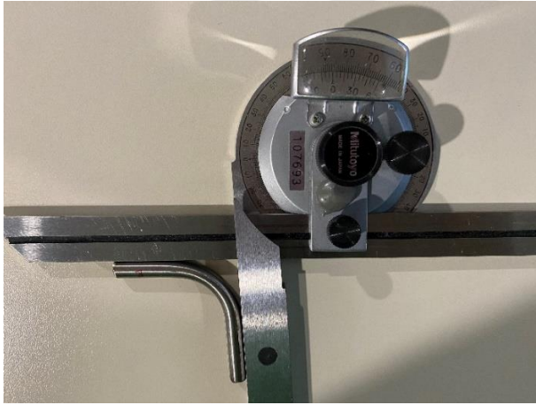
Resim 4.18. Deney 6.3 geri yaylanma değeri
