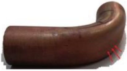
Resim 2.19. Boru parçası kesit daralması [14]
