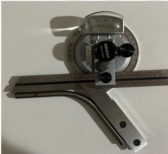
Resim 4.15. Deney 5.3 geri yaylanma değeri
