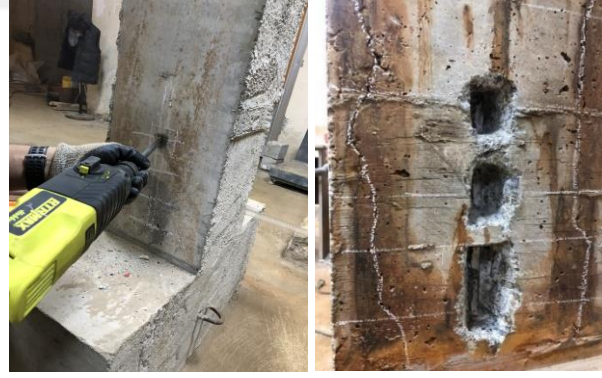
Şekil 3.11 : Birim şekil değiştirme ölçerler uygulama bölgeleri.
