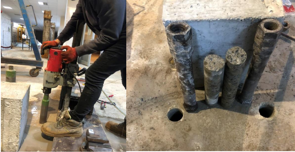
Şekil 3.8 : Deney düzeneğinin kurulumu (a) Bulon yuvalarının hazırlanması, (b) Yanal yükleme bulonlarının hazırlanması.
