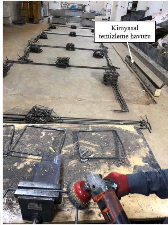
Şekil 4.4 : Mekanik ve kimyasal temizleme işlemi.
