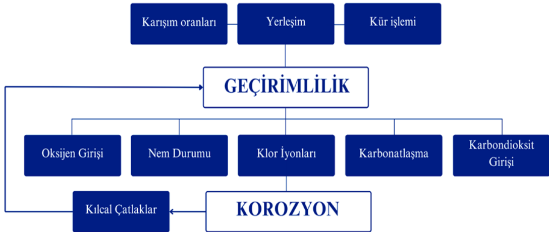
Şekil 1.3 : Korozyon ve beton geçirimliliği arasındaki ilişki.
