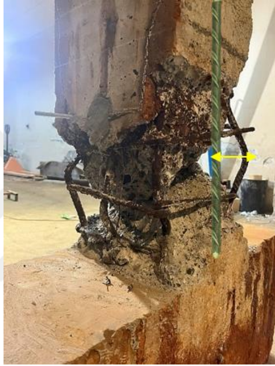
Şekil 1.13 : Boyuna donatıda burkulma ve etriyelerin açılması.
