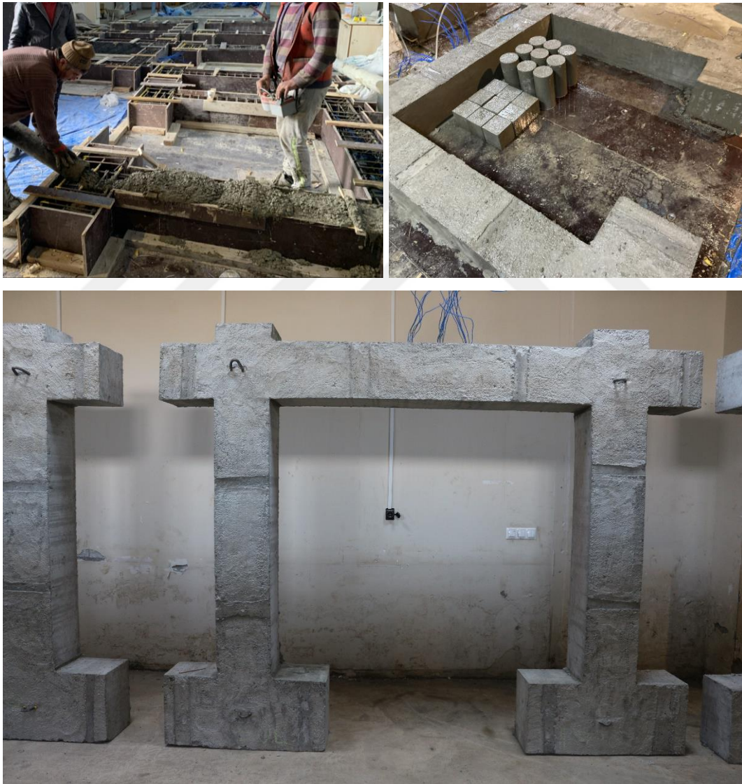
Şekil 3.5 : Numunelerin üretilmesi (a) Beton dökümü, (b) Kür işlemi, (c) Deney numuneleri.
