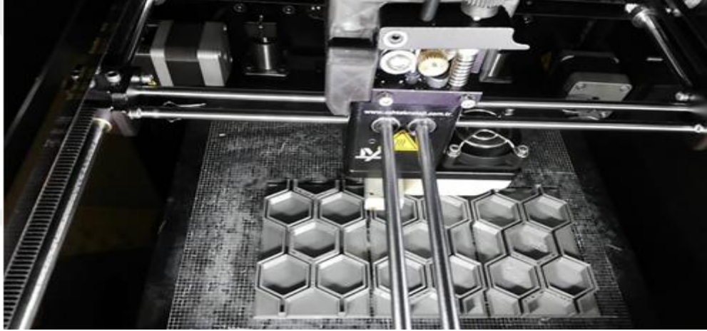
Şekil 6.1 Balpeteği çekirdek kısmının üç boyutlu yazıcı kullanılarak imalatı
