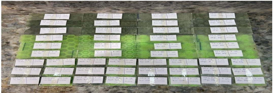
Şekil 6.12 Yapıştırıcının kuruması sonrası deneye hazır olan balpeteği kompozit numuneler
