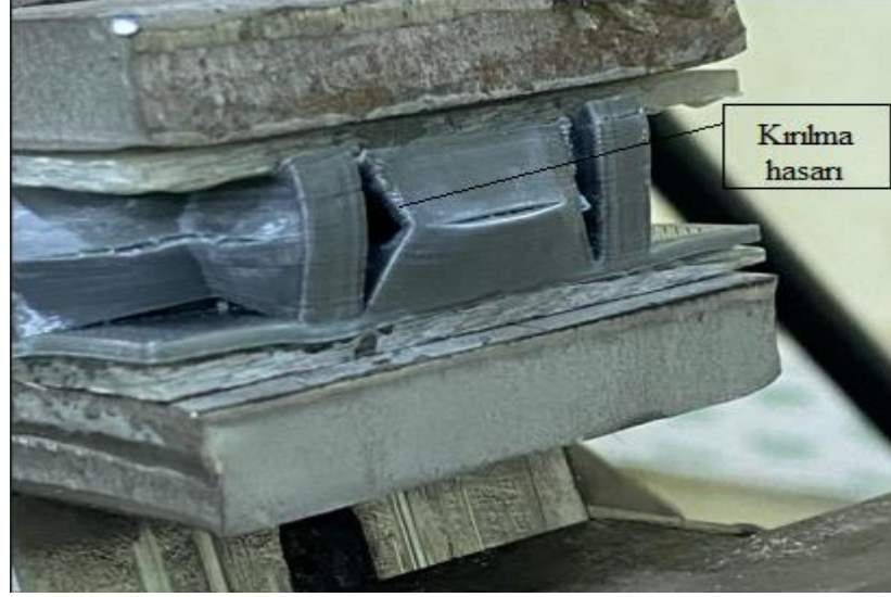
Şekil 7.31 B-TİP3-PLA-KS-1 nolu numunede oluşan hasar
