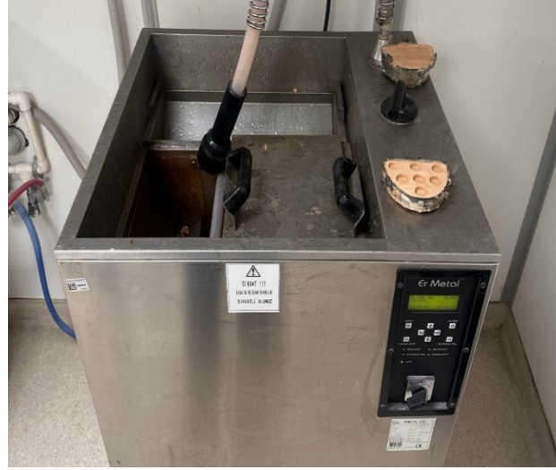
Şekil 3.2: Sıcak akrilik materyalinin yerleştirilmesi için mum örneklerin sıcak su ile giderilmesi.
