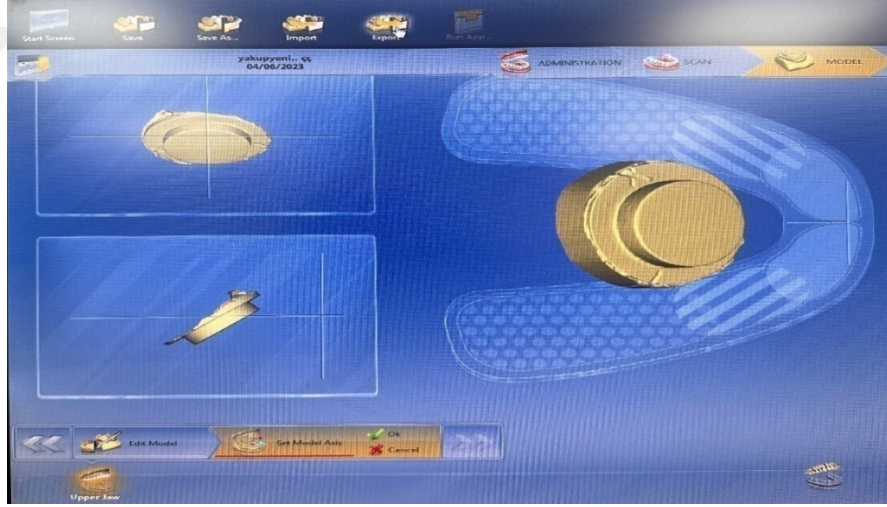
Şekil 3.21: Örneklerin taramalarının gerçekleştirilip STL verilerin elde edilmesi.
