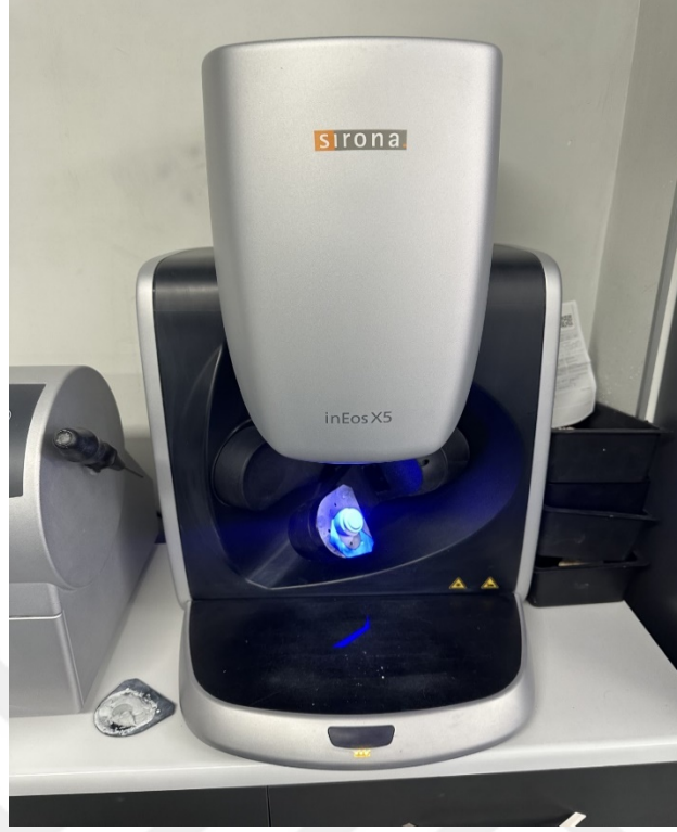
Şekil 3.20: Sirona inEos X5 laboratuvar tarayıcısına örneklerin yerleştirilmesi.
