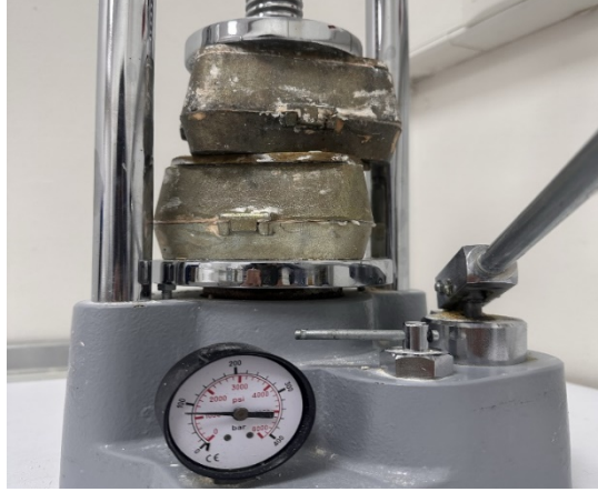
Şekil 3.4: Muflaların 80 bar basınç altında bekletilmesi.
