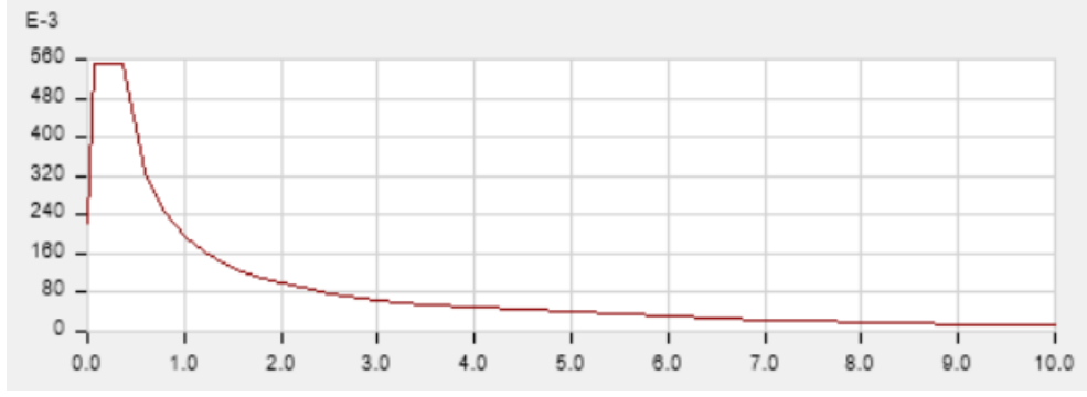
Şekil F.12: ETABS 2020 üzerinde DD-2 yatay tasarım spektrumu.
