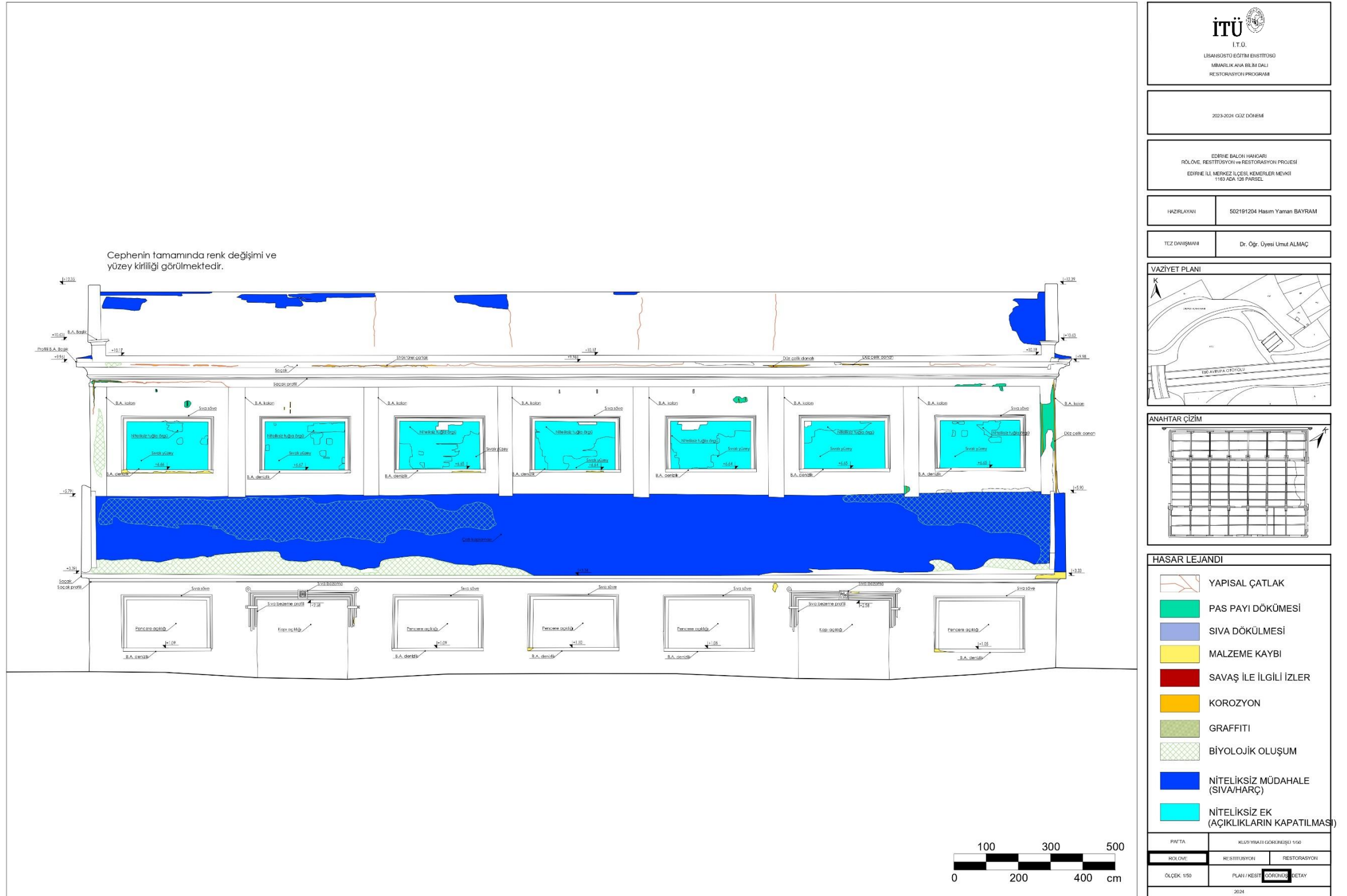
Şekil E.46: Hasar Analizi,Kuzeybatı Görünüşü.
