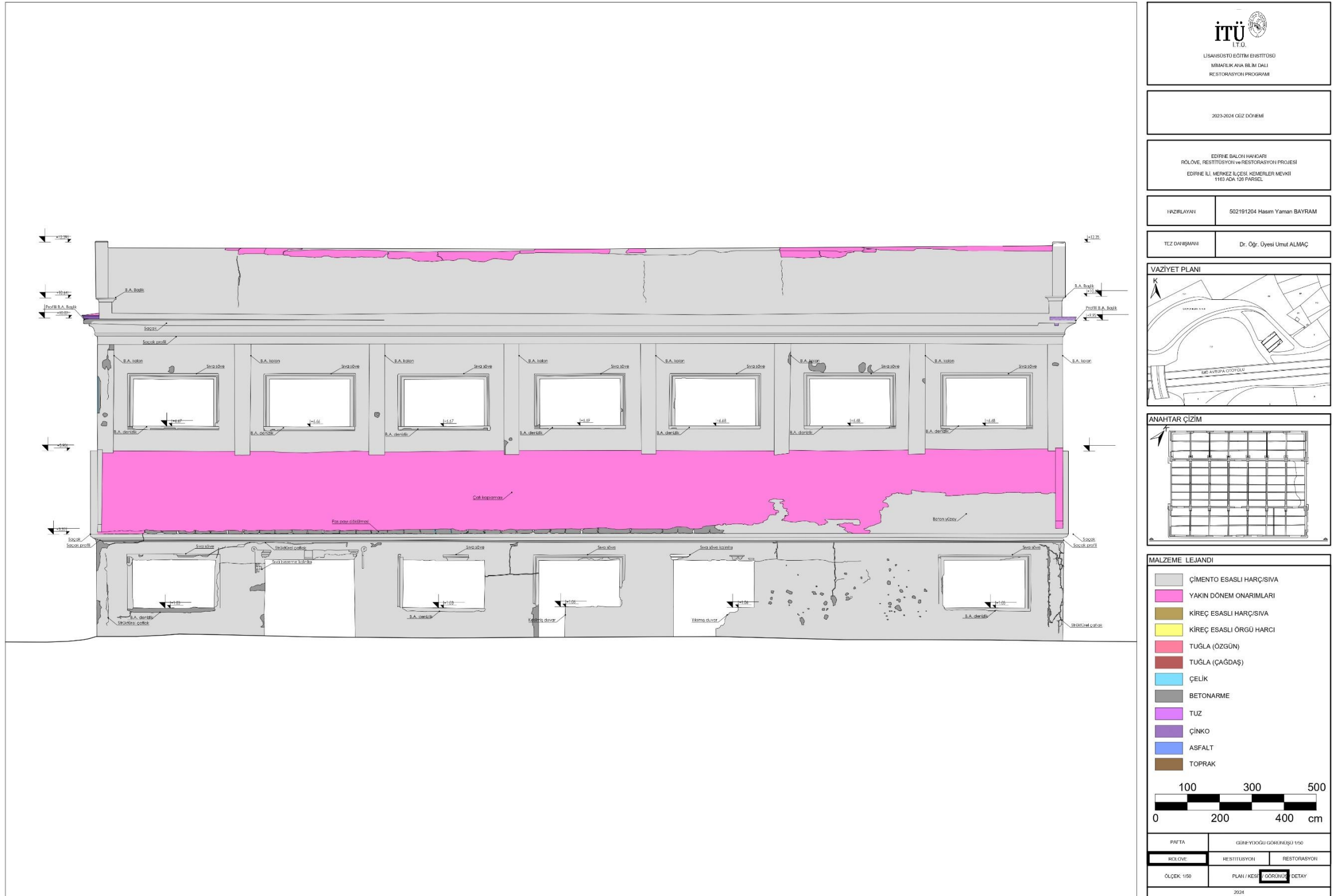
Şekil E.30: Malzeme Analizi, Güneydoğu Görünüşü.
