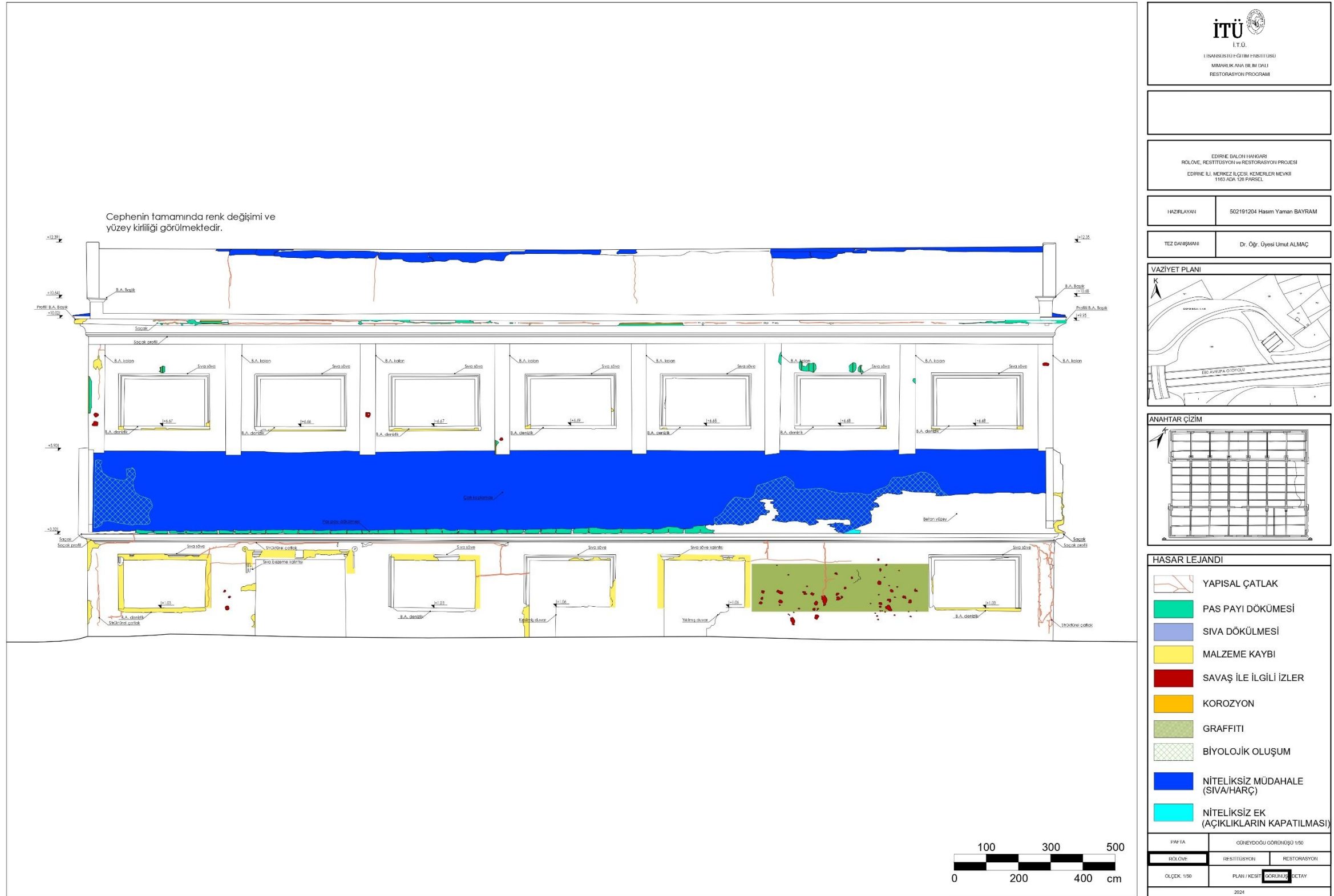
Şekil E.44: Hasar Analizi, Güneydoğu Görünüşü.
