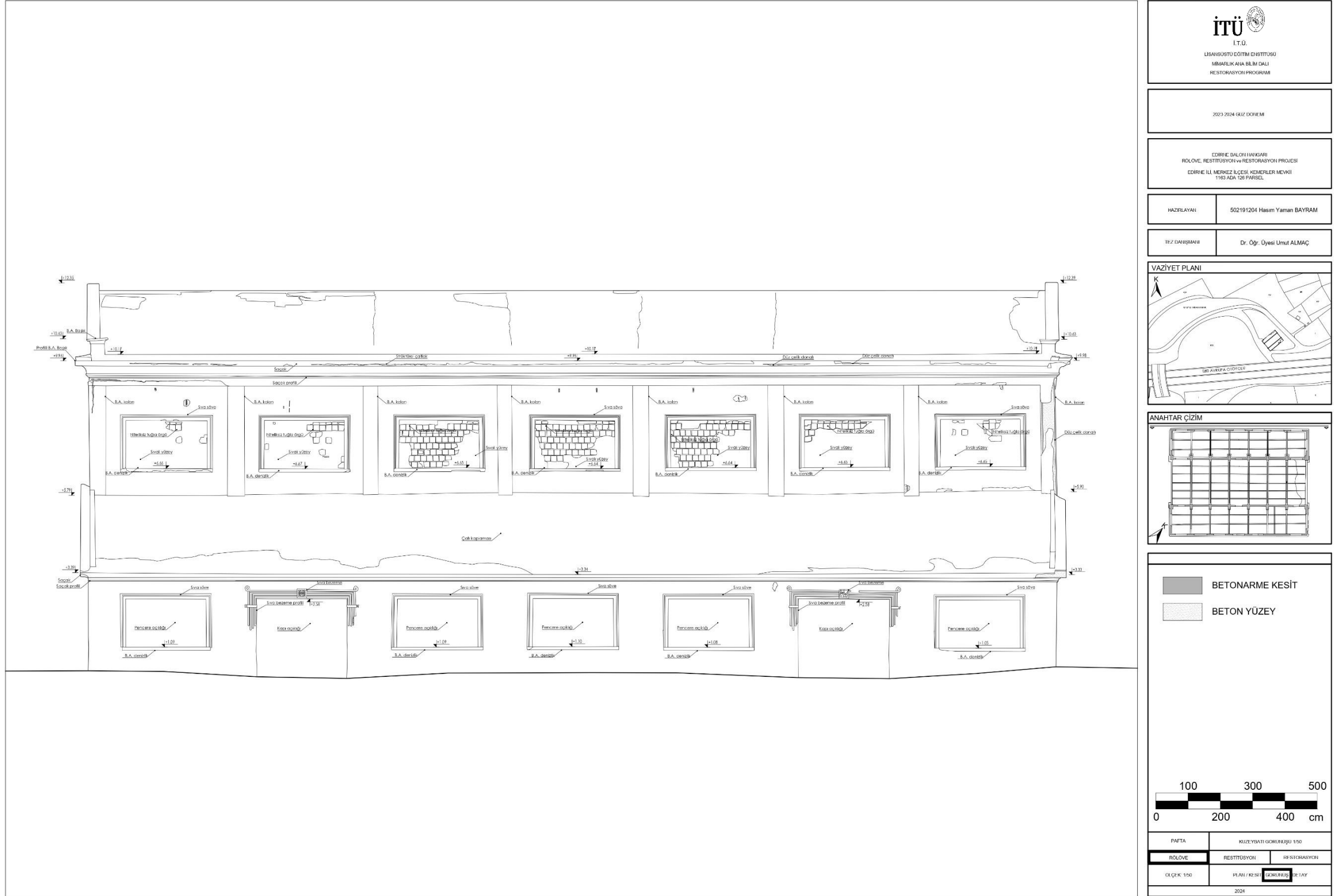
Şekil E.17: Rölöve, Kuzeybatı Görünüşü.
