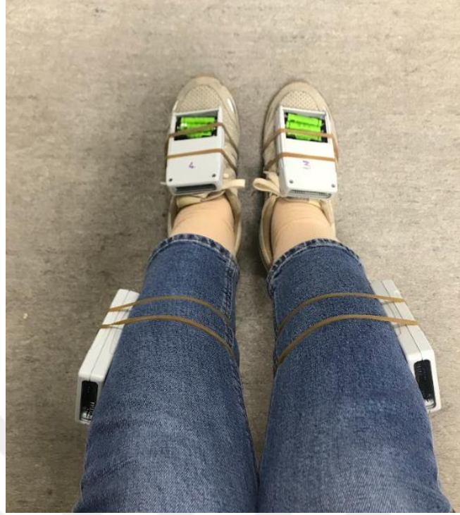
Şekil 36. IMU modüllerinin veri toplamak için bağlandıkları konumları
