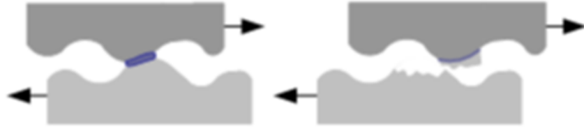
Şekil 3.10. Adhezif Aşınma (Kopeliovich, 2023)
