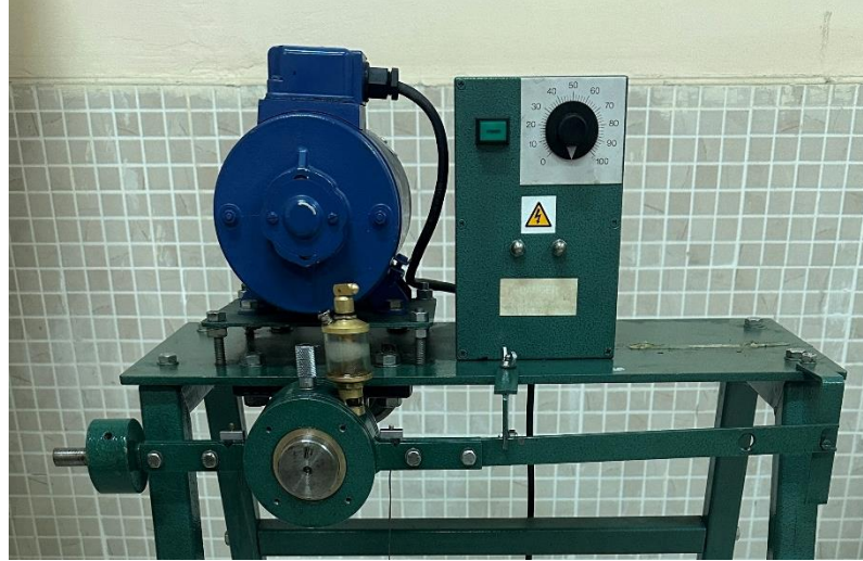
Şekil 4.5. Yağlayıcı ve Sıcaklık ölçüm yuvası Görünümü
