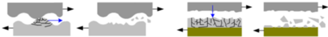
Şekil 3.11. Yorulma Aşınması (Kopeliovich, 2023)
