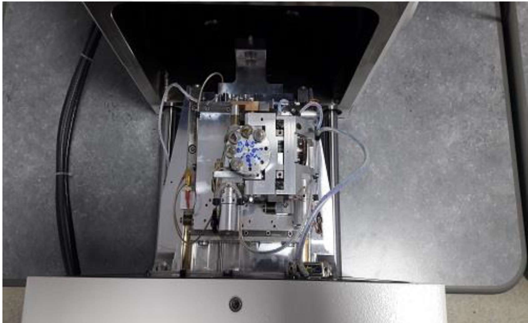
Şekil: 3.12 Taramalı elektron mikroskobu (SEM-EDX) numune yerleştirme bölümü
