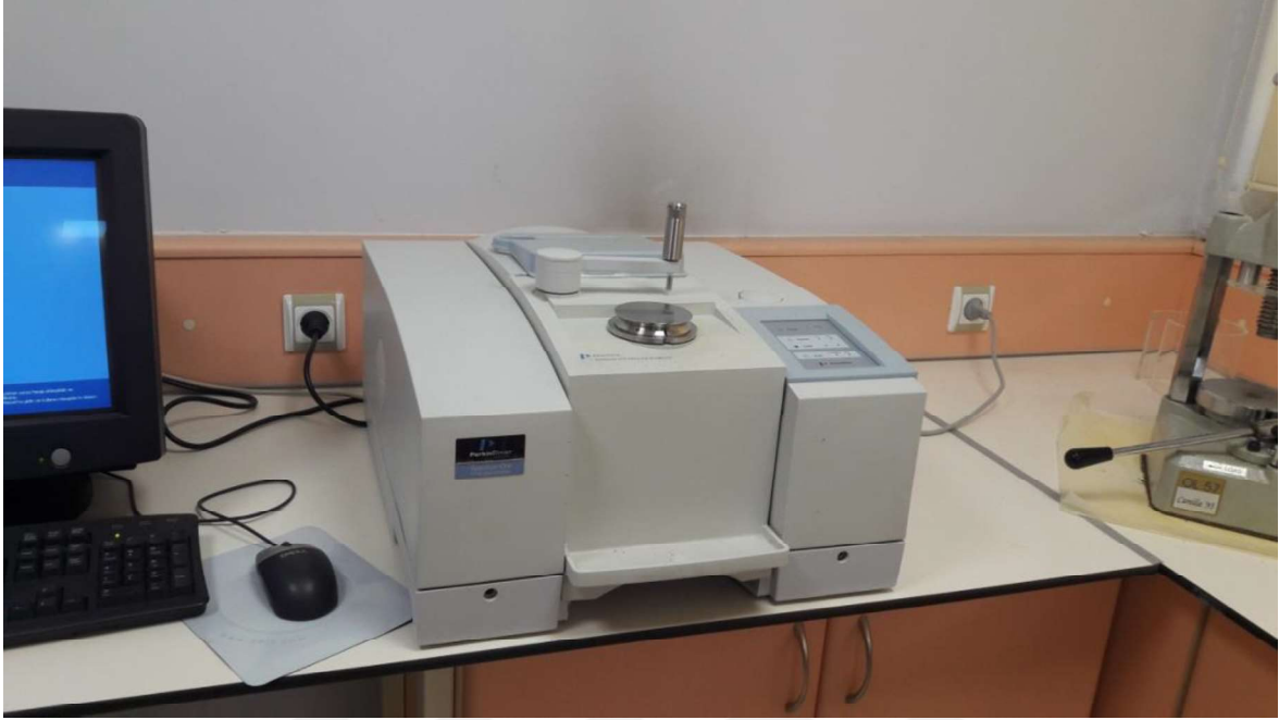
Şekil:3.9 FTIR cihazının genel görünümü
