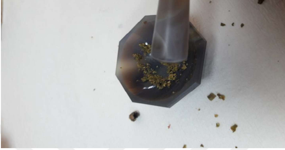
Şekil:3.2 Havanda numuneyi toz hale getirme
