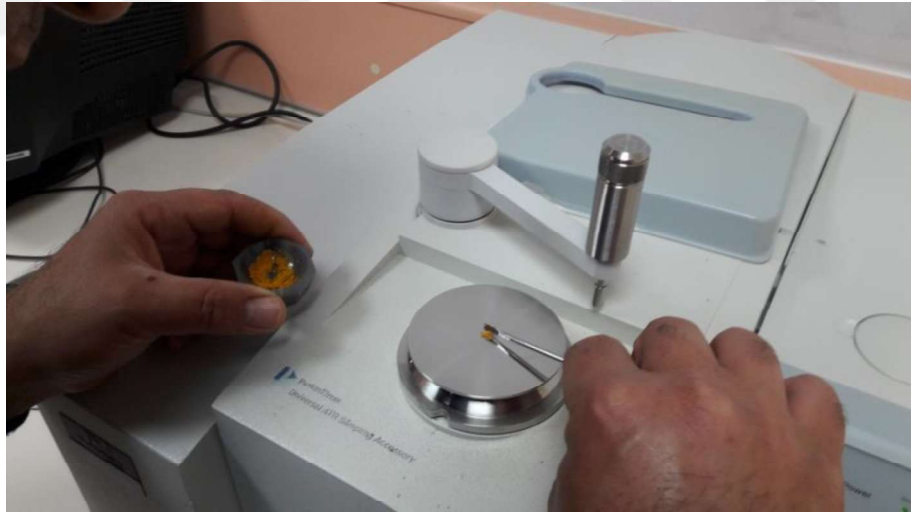
Şekil:3.10 FTIR cihazına numune verme
