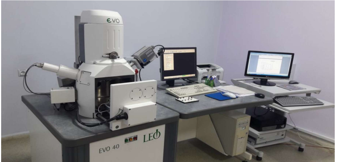
Şekil:2.3 Taramalı elektron mikroskobu (SEM)
