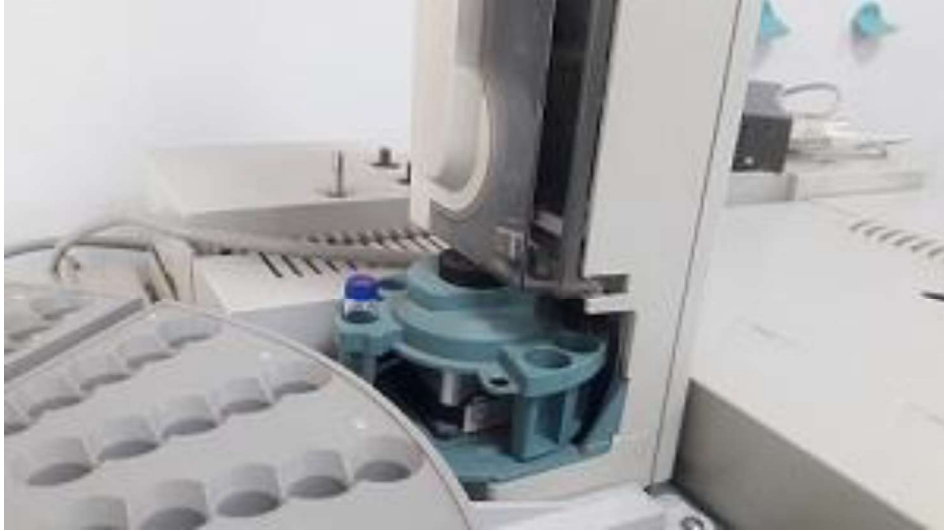
Şekil:3.8 GC-MS numune verme kısmı
