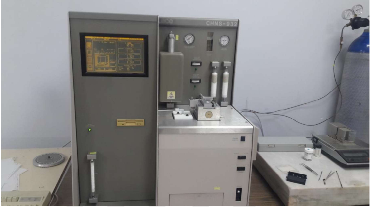
Şekil:2.4 Elementel analiz cihazı
