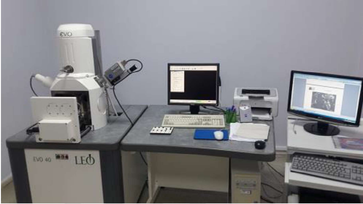
Şekil:3.11 Elektron mikroskobu (SEM-EDX)
