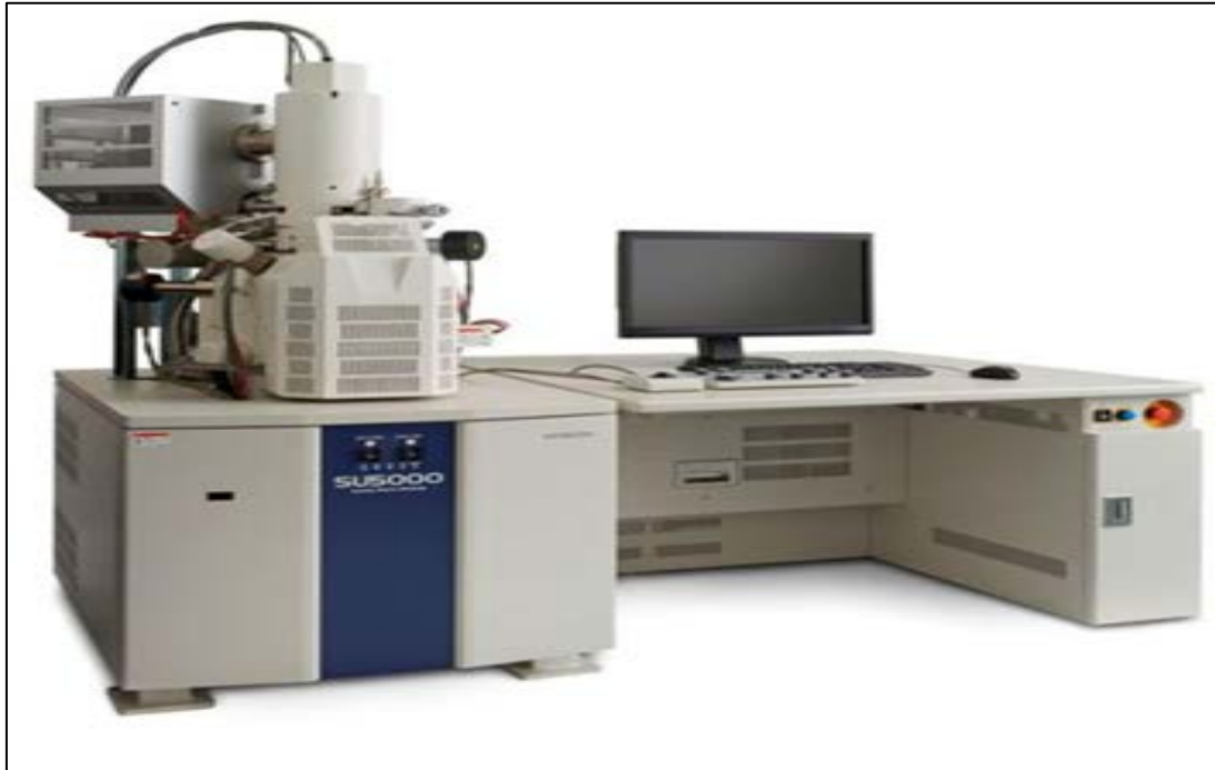
Resim 4.1. Hitachi Su5000 Alan Emisyonlu Taramalı Elektron Mikroskobu
