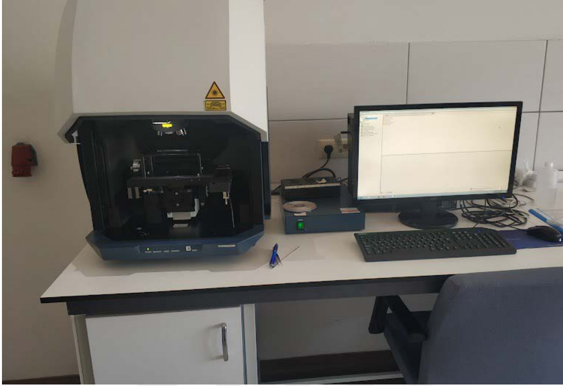
Resim 4.5. JASCO NRS4500 Konfokal Mikroskoplu Raman Spektrometresi
