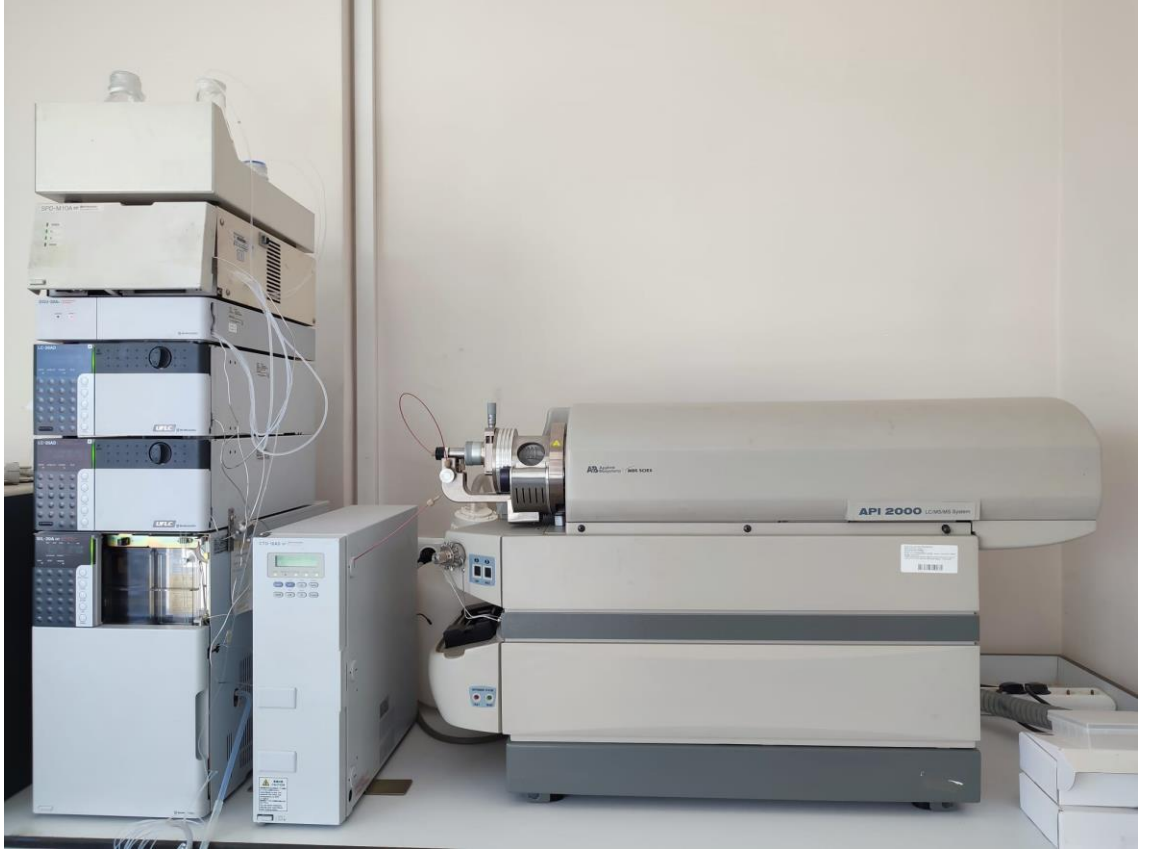
Fotoğraf 14. Analizde kullanılan Shimadzu Prominence LC-20A Model HPLC cihazı
