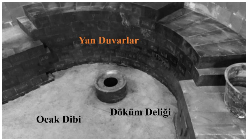
Şekil 2.3 : EAO iç konstrüksiyon görüntüsü (Biswas & Sarkar, 2020).
