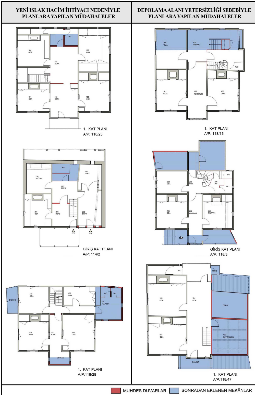
Şekil 6.11 Planlarda gözlenen özgün biçimlenişe aykırı müdahaleler (2023)
