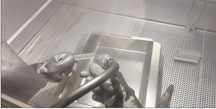
Resim 3.5. Numunelerin iç kısmında kalan sinterlenmiş tozların PRS cihazında temizlenmesi işlemi
