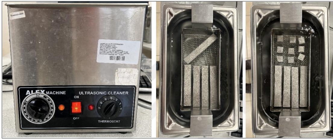
Resim 3.9. Ultrasonik temizleme cihazında numunelerin temizlenmesi
