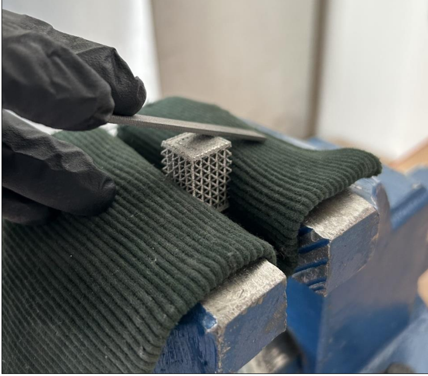
Resim 3.6. Numunelerin destek yapılarından ayrılan yüzeylerinin eğelenmesi işlemi
