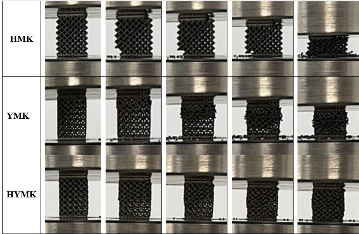
Resim 4.3. Basma numunelerinin aşamalı test görüntüleri
