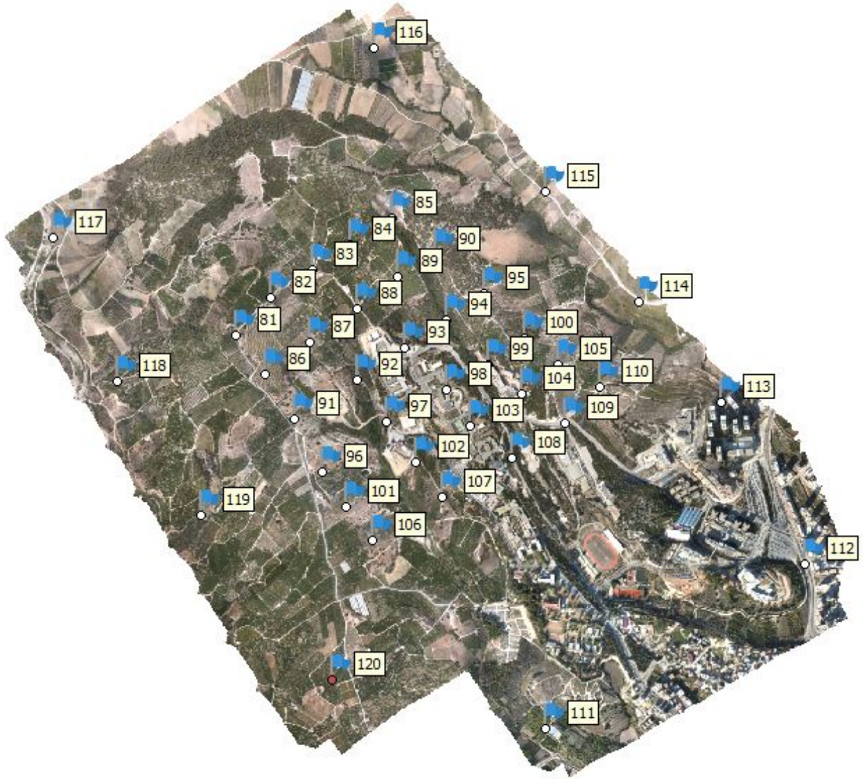
Şekil 4.5. YKN' lerin çalışma alanının merkezinde homojen kurulumu.
