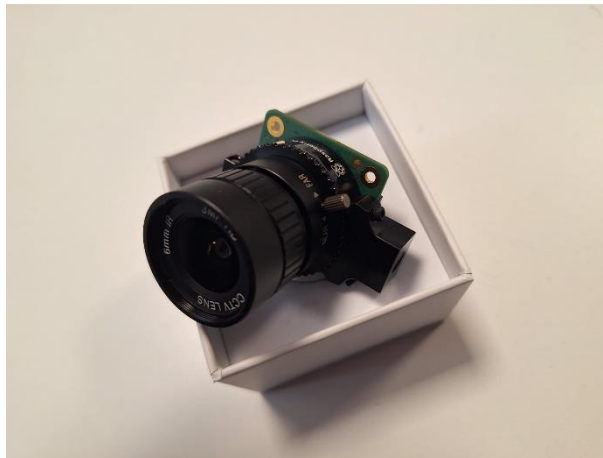
Şekil 5.12 : IMX477 sensörlü kamera ve PT361060M3MP12 CS montaj lensi.
