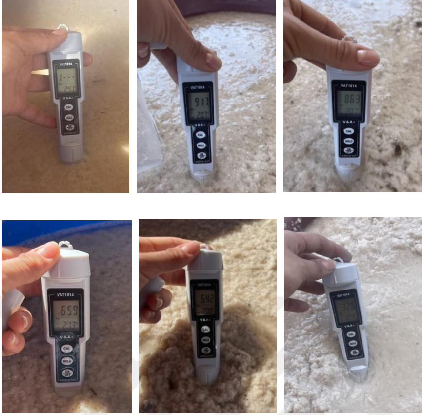
Şekil 4-51: Uygulama sonrası kağıt hamurunda tuz ölçüm sonuçları (HS-A, 2022)
