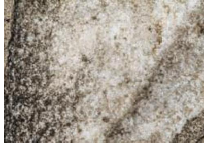
Şekil 2-19: Taş Yüzeyinde Şekerlenme
