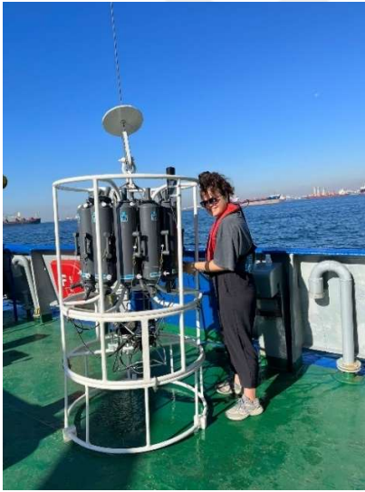
Şekil 12. Rozet sistemi aracılığıyla örnekleme
