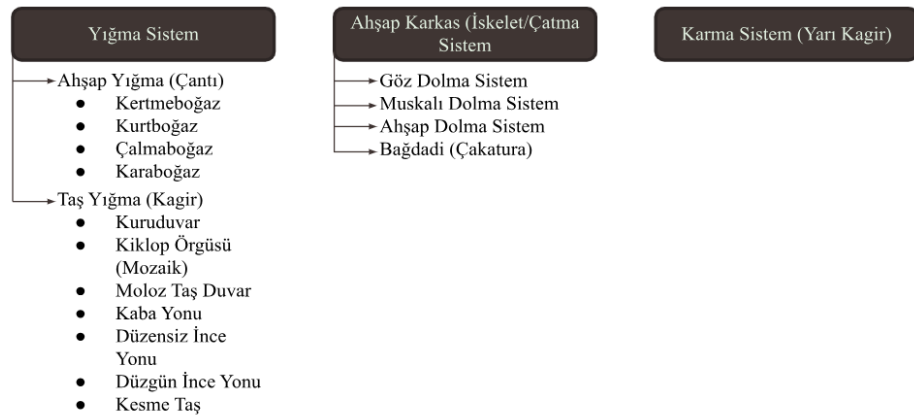
Şekil 5.1. Karadeniz Bölgesinde geleneksel ahşap yapım teknikleri (Özgüner, 1970; Güler ve Bilge, 2013)
