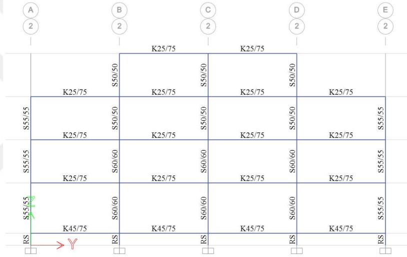
Şekil 3.7 : 2, 3, 4, 5 ve 6 eksenlerine ait taşıyıcı sistem planı.
