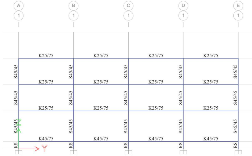
Şekil 3.6 : 1 ve 7 eksenlerine ait taşıyıcı sistem planı.
