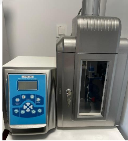
Şekil 3.1. Endüstriyel posa örneklerinin analize hazırlanmasında kullanılan ultrasonik homojenizatör
