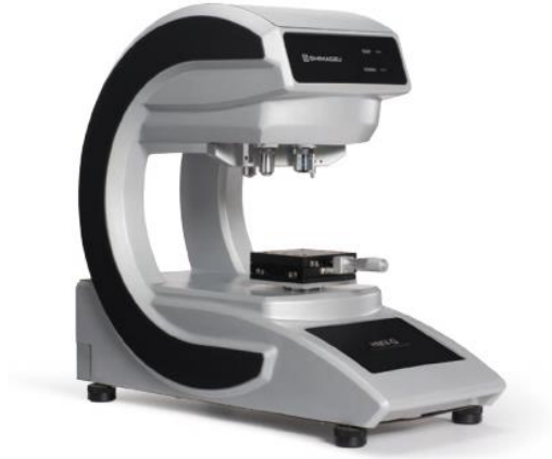
Şekil 3.8: HMV-G Serisi Mikro Vickers Sertlik Cihazı (Shimadzu, Japonya).
