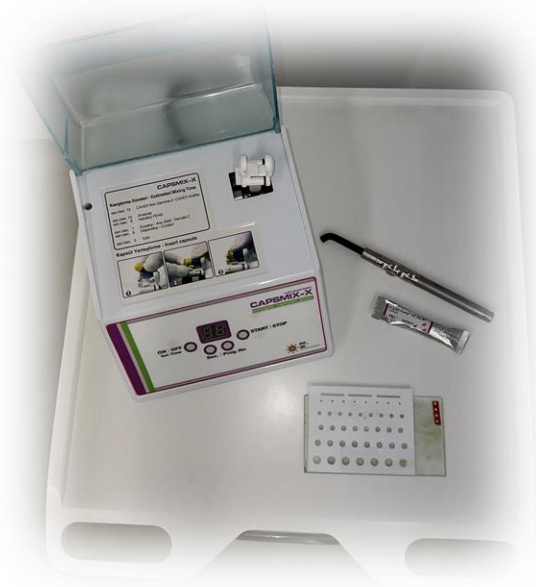
Şekil 3.16: CAPSMIX-X Cihazında Equia Forte HT Fil Disklerin Hazırlanması.
