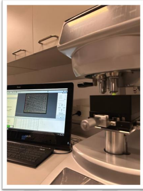
Şekil 3.27: Örneklerin Vickers Sertlik Cihazı ile Mikrosertlik Ölçümü.
