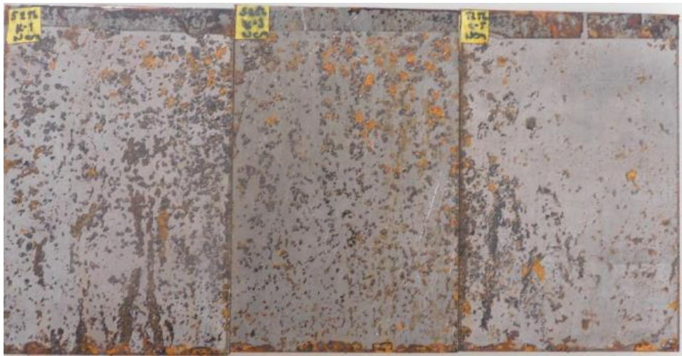
Şekil 4.33. Plaka 7 (kaplamasız çelik) 120 saat nem testi sonrası
