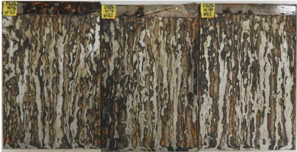
Şekil 4.18. Plaka 7 (kaplamasız çelik) 120 saat tuz püskürtme testi sonrası
