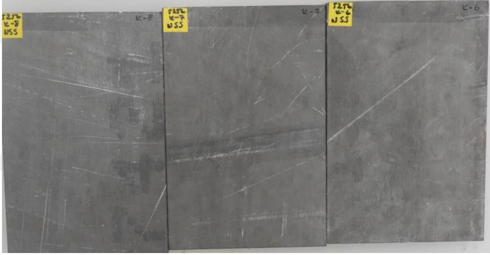
Şekil 4.17. Plaka 7 (kaplamasız çelik) tuz püskürtme testi öncesi
