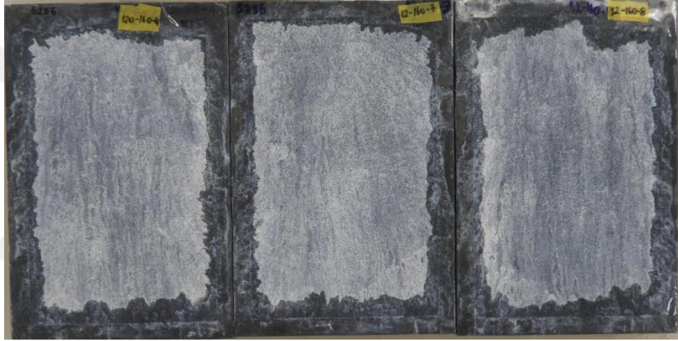
Şekil 4.8. Plaka 2 (160 µm-12 cm) 120 saat tuz püskürtme testi sonrası
