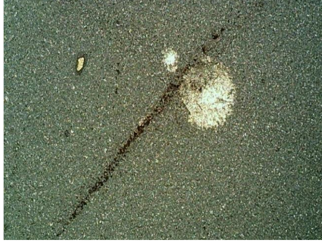
Şekil 4.38. Plaka 5 (160 \mu m-24 cm) numunesinde oluşan kaplama çatlağı
