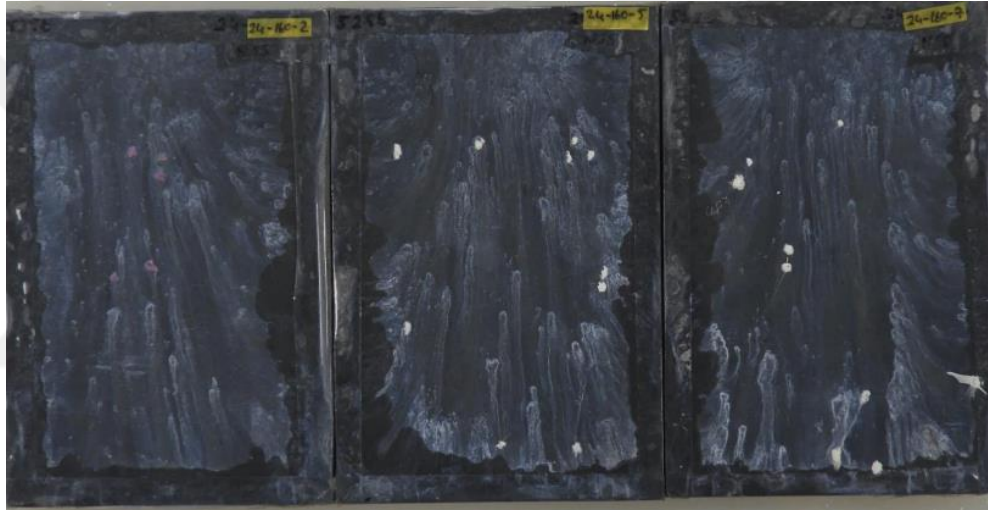
Şekil 4.14. Plaka 5 (160 µm-24 cm) 120 saat tuz püskürtme testi sonrası
