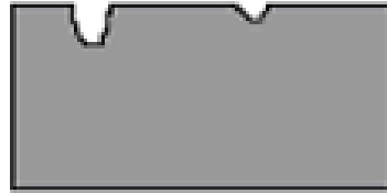
Şekil 1.9. Çukurcuk Korozyonu (Stm Coatech, 2016)
