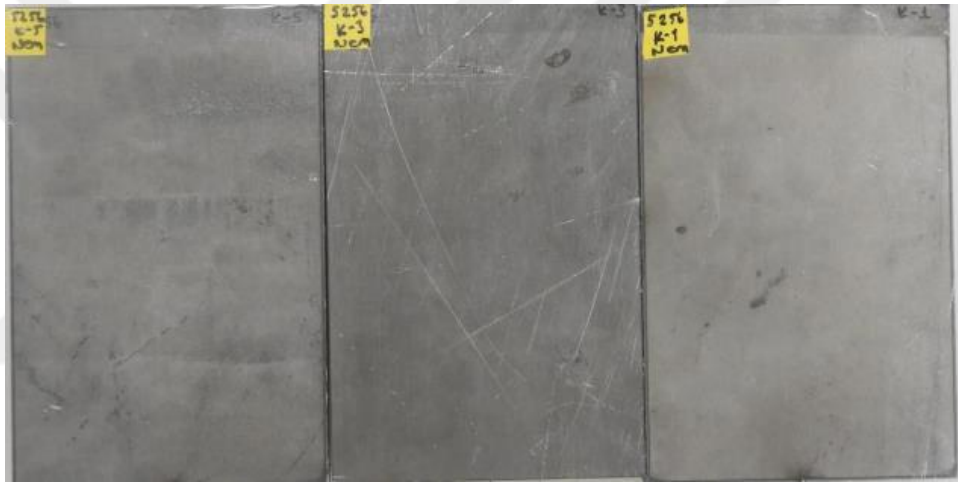
Şekil 4.32. Plaka 7 (kaplamasız çelik) nem testi öncesi
