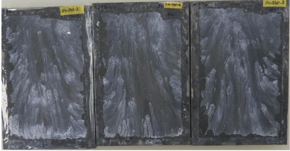
Şekil 4.16. Plaka 6 (240 µm-24 cm) 120 saat tuz püskürtme testi sonrası
