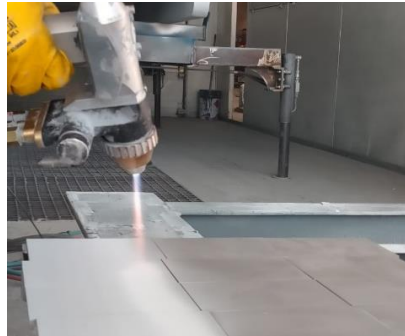
Şekil 3.5. Tel alev sprej kaplama sırasında numunelerin görüntüsü
