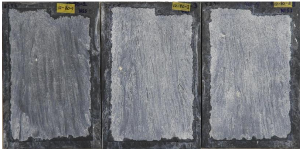
Şekil 4.6. Plaka 1 (80 µm-12 cm) 120 saat tuz püskürtme testi sonrası
