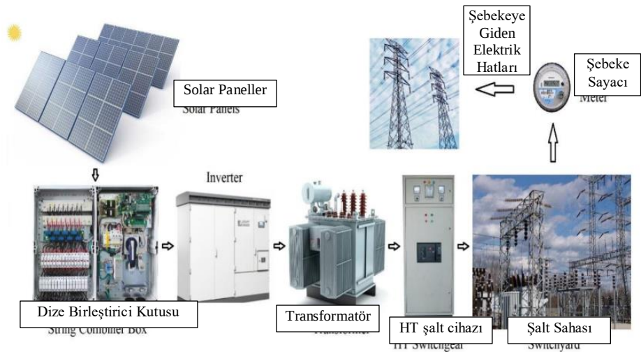
Şekil 2.6: Güneş Enerjisi Santralinin Şematik Diyagramı (Kırbaş Ve Çifçi, 2019).
