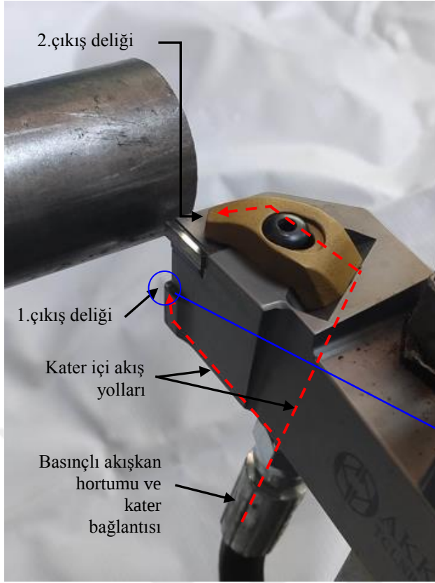
Dıştan Jetting ile soğutma sıvı akış yolları
