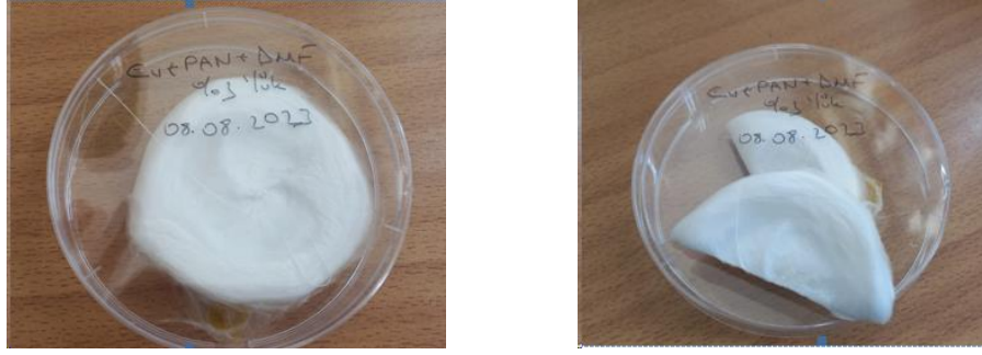
Şekil 3. 13. Elektrosinning ile ürettiğimiz Cu+PAN nanolif
