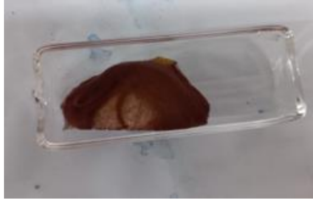
Şekil 3. 14. 300 ^{\circ} C de 5 dk tavllanmış Cu nanolif
