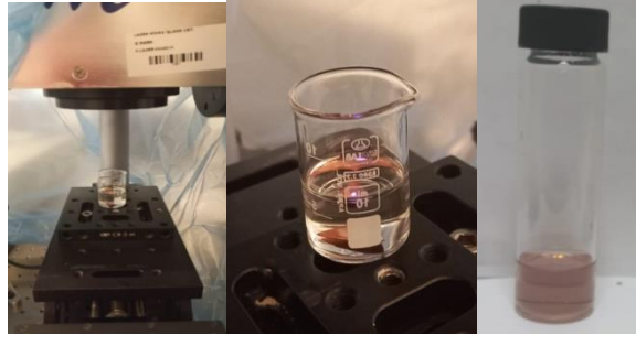
Şekil 3.3. Cu nanoparçacık üretimi
