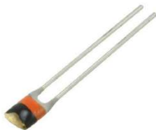
شکل ض.م-الف-6 ترمیستور مورد استفاده در سیستم اندازه گیری ضریب هدایت حرارتی سیال، مدل NTCLE 100E 339JB0 [135].
