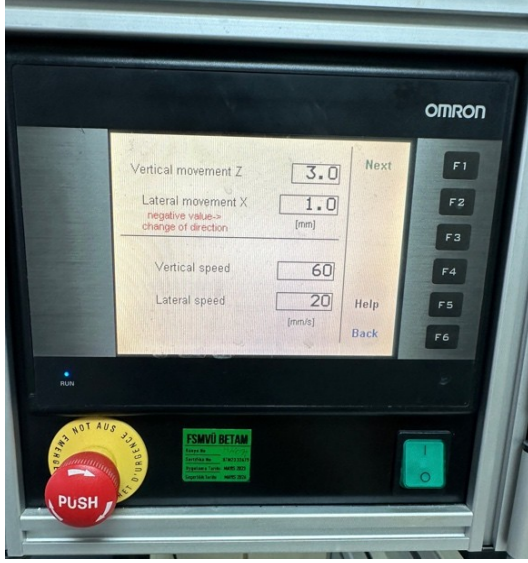
Şekil 3-5. : Çiğneme simülörü bilgisayarlı kontrol paneli
