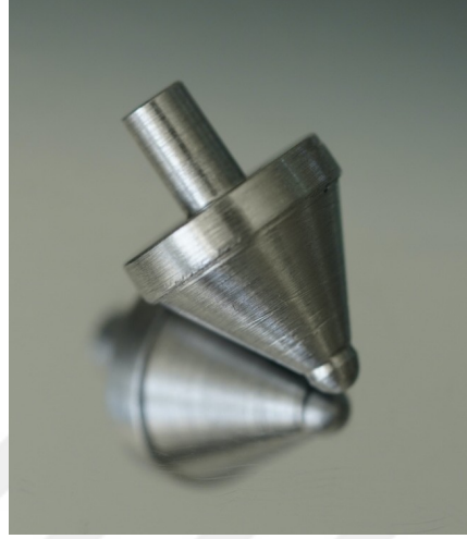
Şekil 3-26: Çiğneme simülatörüne uygun tasarlanan 4 mm çaplı top başlı çiğneyici uç
