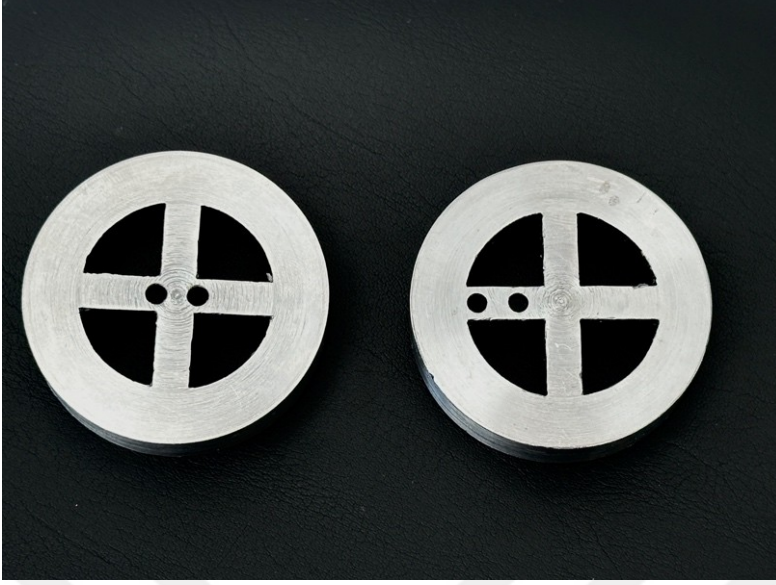
Şekil 3-11: İmplantları akrilik içerisinde pozisyonlandıran çelik düzenekler
