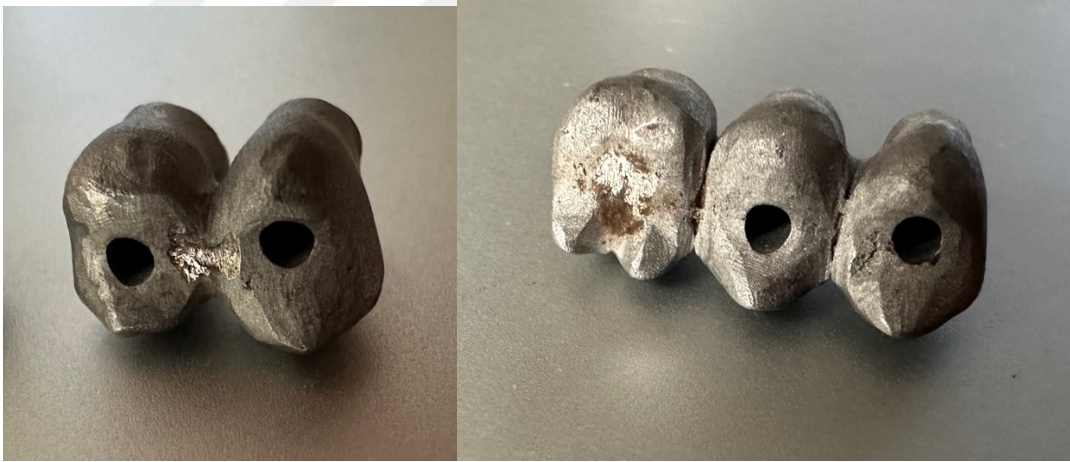
Şekil 4-1: Dinamik yükleme sonrası antagonist ucun temas noktasında görülen aşınma
