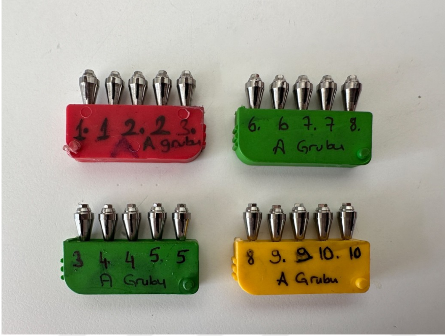
Şekil 3-27: SEM cihazı için örneklerin yerleştirildiği özel plastik tutucular
