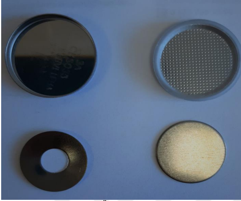
Şekil 3.10. Süperkapasitör Ölçümlerinde Kullanılan Pil Düzenegi
