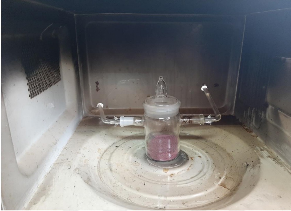
Şekil 3.8. Modifiye Edilmiş Mikrodalga Destekli Karbon Üretim Deney Düzeneği
