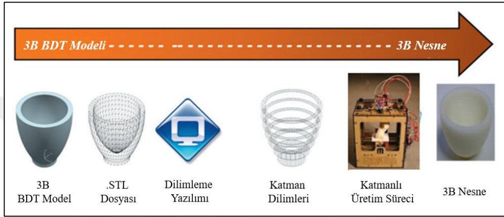
Şekil 2. Üç Boyutlu Yazıcılarda Üretim Süreci
