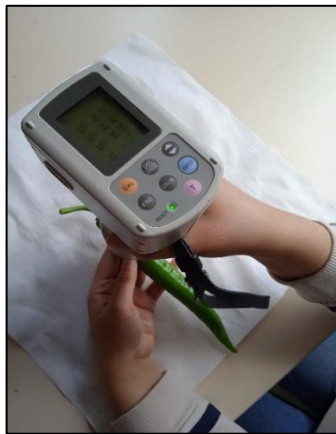
Şekil 3.7. Meyve renk ölçümü
