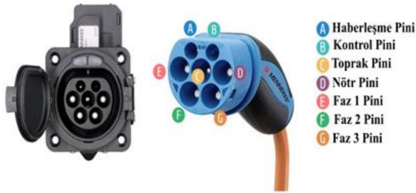
Şekil 10. Tip 2 EA şarj soketi ve sokette yer alan pinler (Society of Automobile Engineers Standard, 2010).
