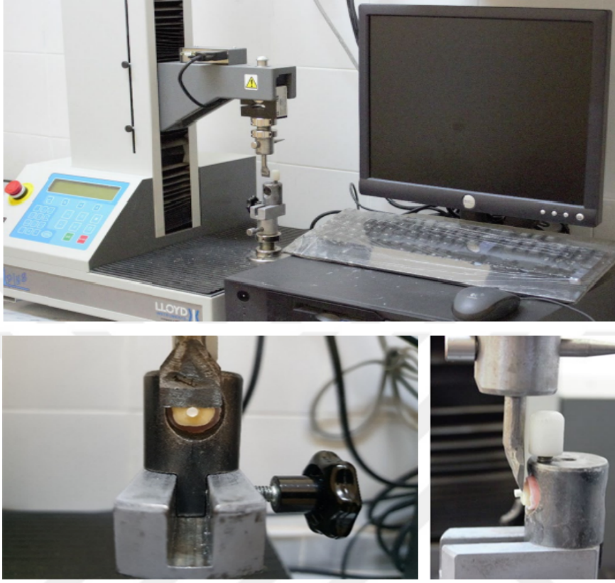
Şekil 3. 12. Universal test cihazı ve makaslama bağlanma dayanımı testi
