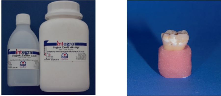
Şekil 3. 1. Soğuk akrilik ve akriliğe gömülü çekilmiş diş örneği
