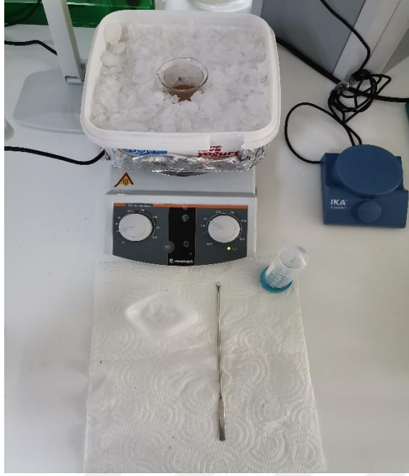
Şekil 2. 2. Amonyum sülfat çöktürme işlemi
