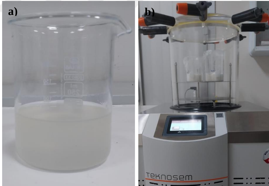
Şekil 2.3 Chia müsilajının kuru formda eldesi. a) Çekirdeklerinden arındırılmış chia müsilajı, b) chia müsilajının liyofilizatör cihazı ile kurutulması.
