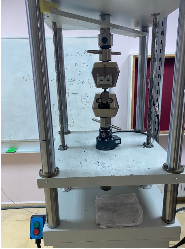
Resim 4.7. Basma testlerinin gerçekleştirildiği UTEST universal basma cihazı
