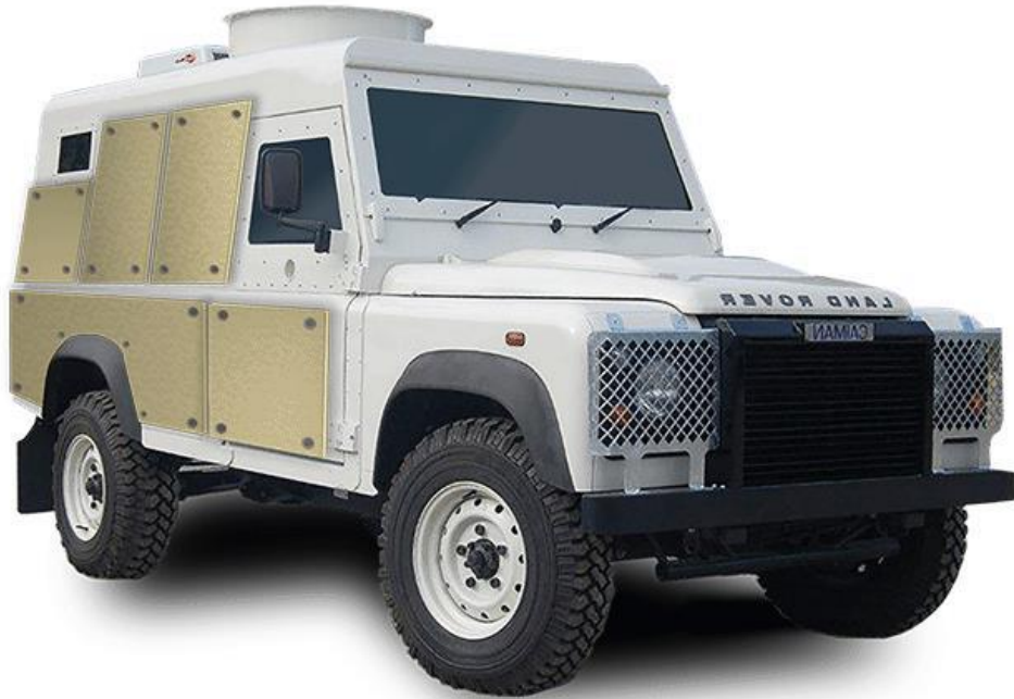
Şekil 1.2. Aplike zırh sisteminin araç üzerindeki görünümü
