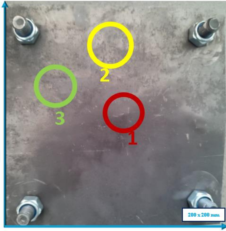
Şekil 8.14. Üçüncü zırh konfigürasyonu arkadan atış sonrası görünümü
