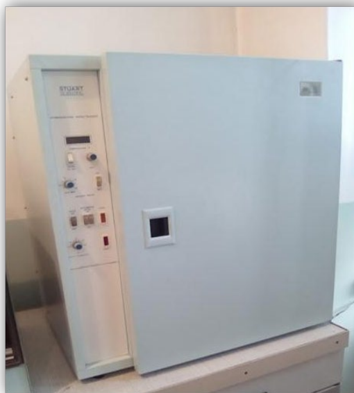
12-сүрөт. Микропробиркалардын термостатка (37°C) жайгаштырылышы(Термостат STUART SCIENTIFIC).
