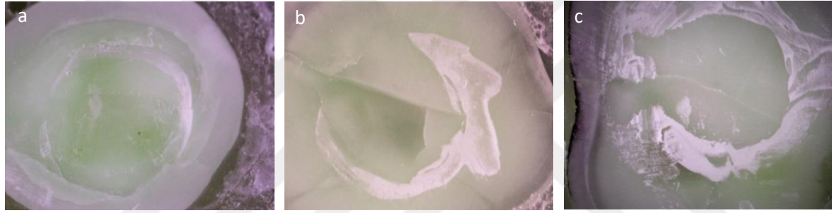
Resim 4.1. Rely-X Ultimate simanda görülen kırık tipleri, (a) adeziv kırık, (b) koheziv kırık, (c) karma kırık
