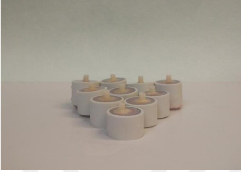
Resim 3.8. SBF’de bekletmek için hazırlanan örnekler
