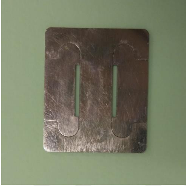
Resim 3.1. Üç nokta bükülme dayanımı testi için örneklerin hazırlanmasında kullanılan çelik kalıp
