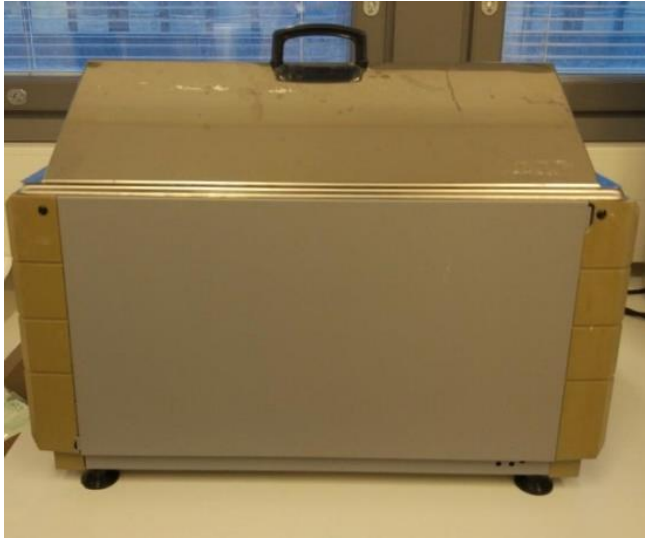
Resim 3.4. Örneklerin SBF içinde 2 hafta bekletildiği çalkalamalı inkübatör
