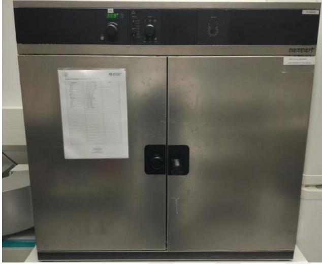
Resim 3.3. Örneklerin 24 saat kuru olarak bekletildiği inkübatör
