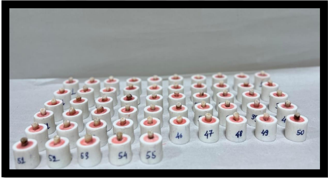
Şekil 3.20.Örneklerin silikon kalıplar içerisinde yerleştirilmesi
