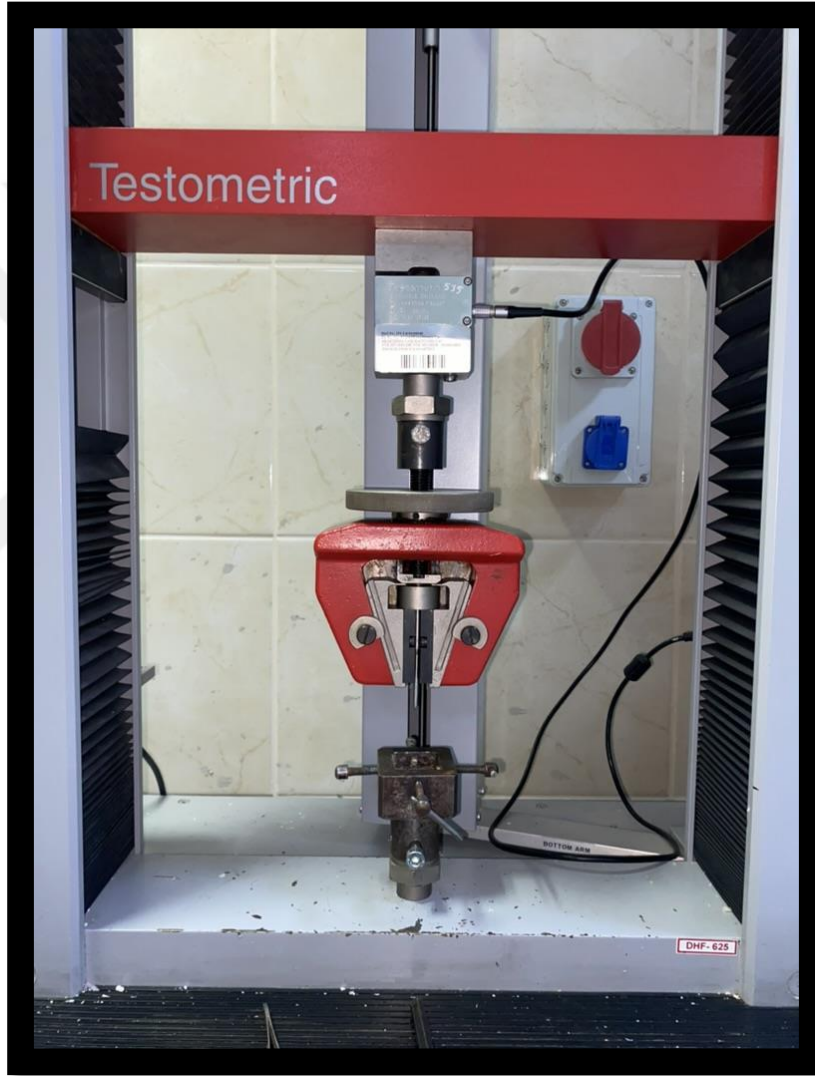
Şekil 3.30.Kırılma deneyinde kullanılan universal test cihaz
