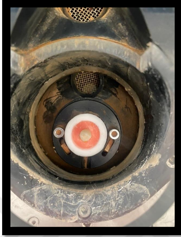
Şekil 3.27. Çiğneme Simülatörüne örnek yüklenmesi
