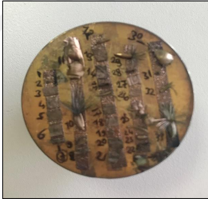
Şekil 3.10 SEM Çekimine Hazırlanan, Sabitlenmiş Altın Kaplamalı Numuneler
