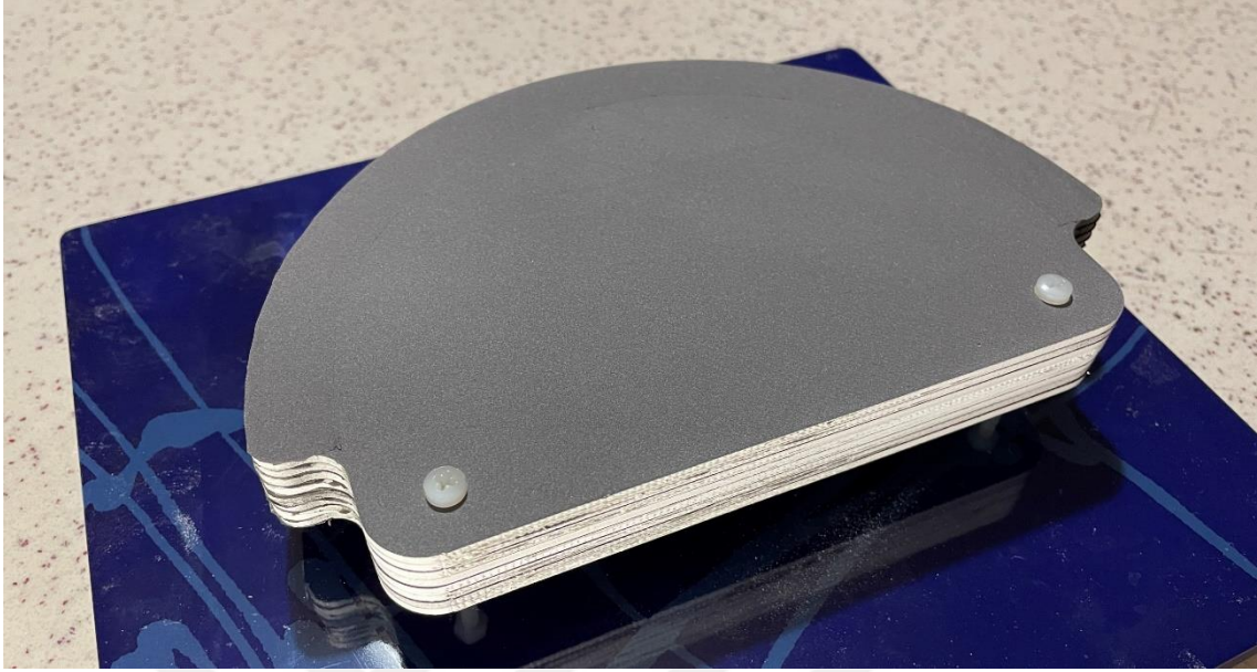
Şekil 5.2 Sekiz elemanlı dielektrik lens anten dizisinin 3B prototipi
