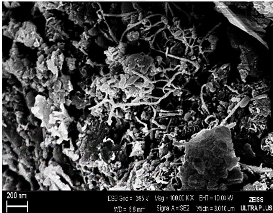
Şekil 9.5. Elektrolitik yol ile elde edilen ürünün ilk saflaştırma sonrası 100000X mikrografı
