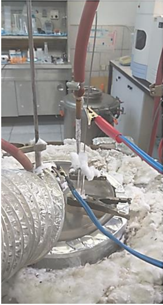
Şekil 8.9. Karbon nanotüp üretim deney düzeneği ve şematik görünümü
