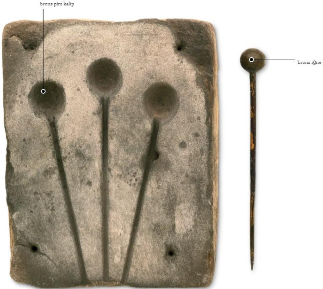
Şekil 1. 9: Kapalı kalıp döküm tekniği
