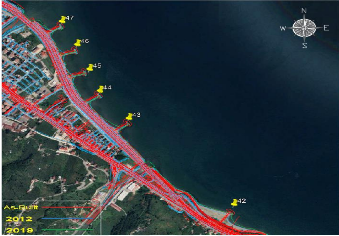
Şekil 25. Araklı'daki kıyı yapıları ve kıyı çizgisinin zamanla değişimi
