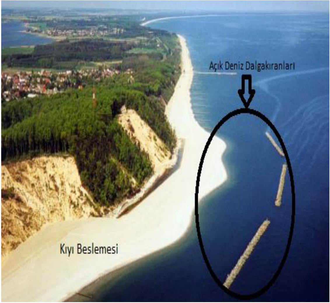
Şekil 14. Açık deniz dalgakıranı ve kıyı beslemesi örneği/Streckelsberg / Usedom Island/Almanya
